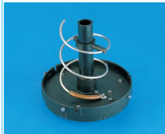
Fig.11 In queste due foto è visibile un adattatore d'impedenza ottenuto con un lamierino e un tubetto di rame lungo 1/4\lambda applicato sulla prima spira.
