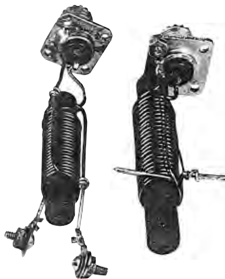
Fig.15 Foto di due trasformatori avvolti su nuclei cilindrici utilizzati per convertire un segnale bilanciato in un segnale sbilanciato. Avvolgendo due soli fili appaiati otterrete un rapporto di 4/1 (vedi fig.8), mentre avvolgendo tre fili appaiati otterrete un rapporto 1/1 (vedi fig.14).
