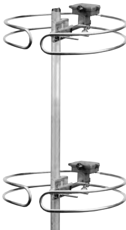
Fig.4 Collegando due folded-dipoli in fase o in opposizione di fase è possibile ottenere un guadagno di circa 4,5 dB. All'interno delle due scatole visibili nella foto sono inseriti dei piccoli trasformatori in ferrite, che provvedono ad adattare l'impedenza del folded-dipole sul valore dell'impedenza del cavo coassiale utilizzato per la discesa, cioè sui 75 oppure sui 52 ohm.
