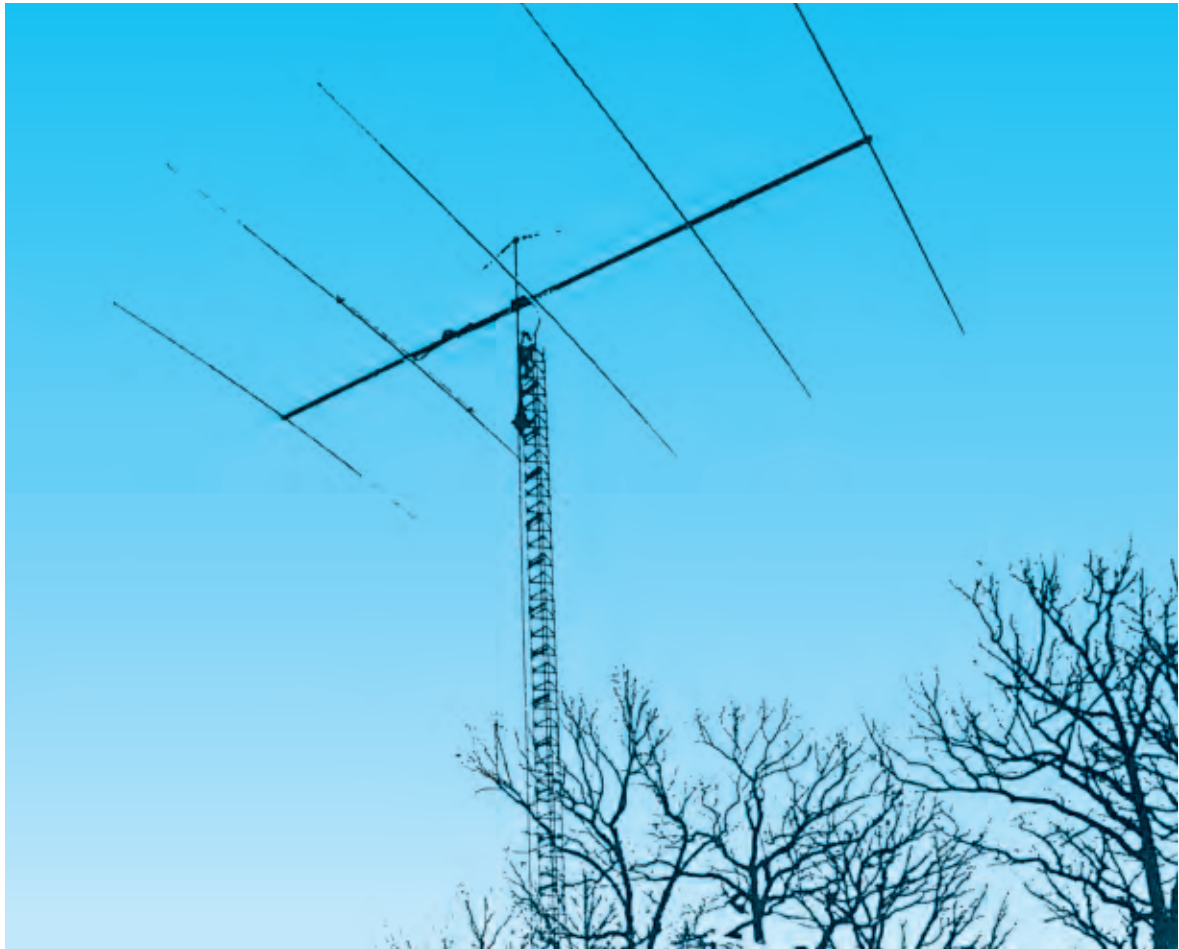
Fig.12 Per calcolare la lunghezza di Riflettore-Dipolo-Direttori e la loro spaziatura in una Yagi composta da 5 elementi, potete utilizzare le formule riportate in questa pagina. Per frequenze fino a 30 MHz consigliamo di usare dei tubi del diametro di 20-25 mm.
