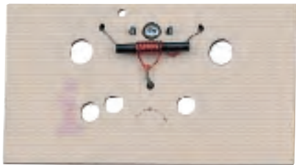
Fig.10 Nelle sole antenne riceventi si usano delle minuscole ferriti del diametro di 2 mm e del filo da 0,25-0,3 mm.
