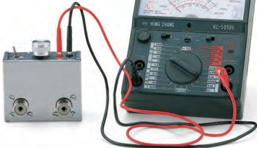
Fig.10 Alle due boccole d'uscita del rosmetro dovete collegare un Tester commutato sulla portata 100 \mu A oppure sulla portata 250 \mu A fondo scala.
