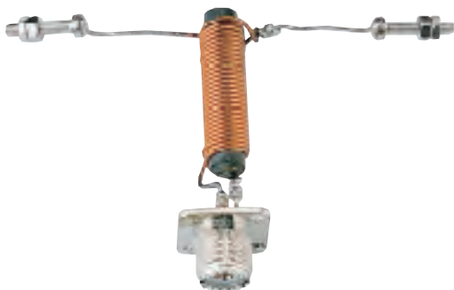
Fig.9 Foto di un trasformatore da bilanciato a sbilanciato avvolto su un nucleo cilindrico in ferroccube.
