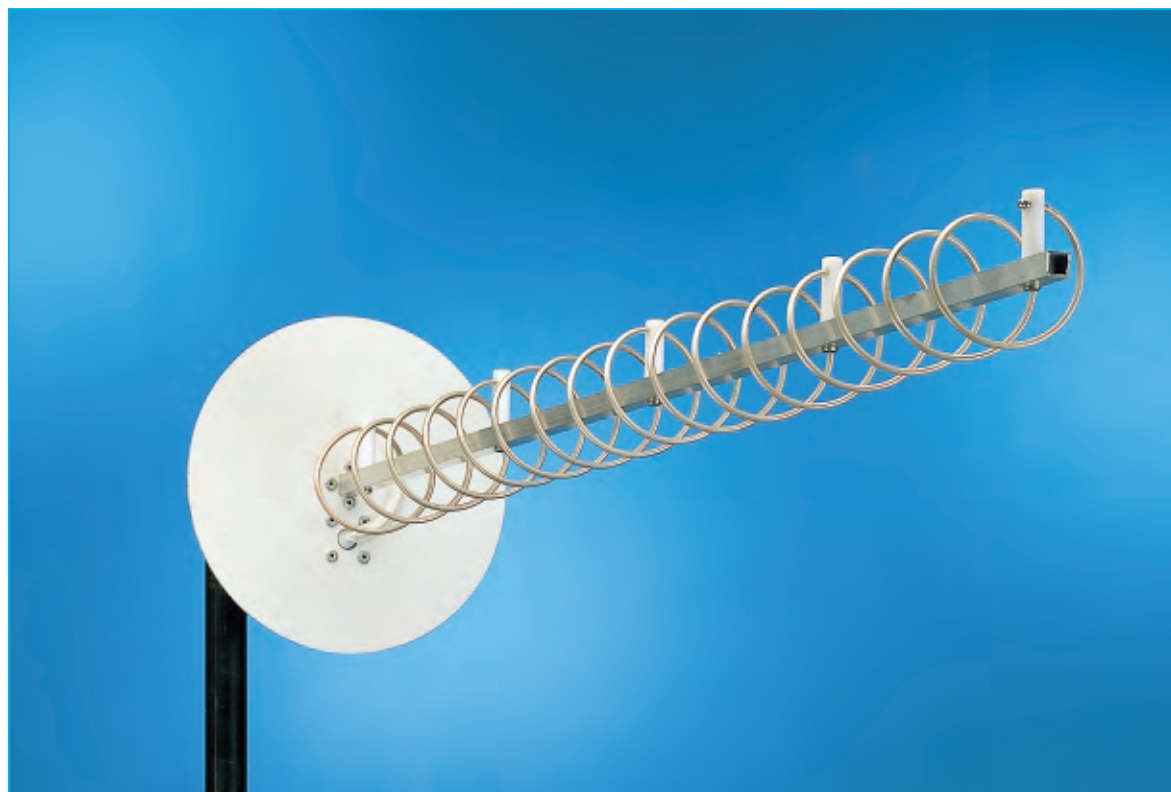
Fig.5 Avvolgendo le spire in senso antiorario , la polarizzazione del segnale risulterà circolare sinistrorsa .
