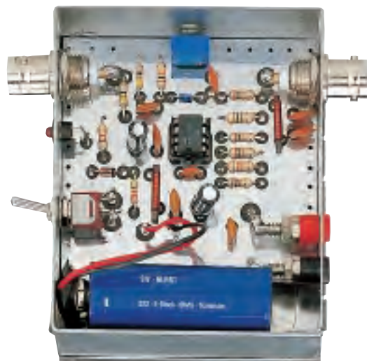
Fig.1 Foto del Ponte che permette di misurare il valore di impedenza di una antenna. Questo ponte può essere usato anche per controllare il rapporto di trasformazione di un Balun o la lunghezza degli spezzoni di cavo coassiale utilizzati come trasformatori d'impedenza da 1/4\lambda .
