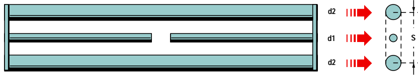
Fig.7 In un dipolo a tre elementi, il tubo d1 va collocato al centro fra i due tubi d2.
