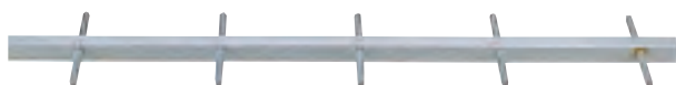
Fig.14 Per le Yagi che lavorano su frequenze maggiori di 300 MHz, se gli elementi vengono fissati sull'asta metallica SENZA isolarli, dovete aumentare la loro lunghezza (in proposito vedi gli esempi riportati nell'articolo).
