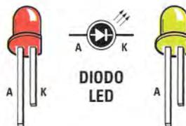
Fig.2 Connessioni dell'integrato 4001 viste da sopra e con la tacca di riferimento rivolta verso sinistra e dei due terminali A-K dei diodi led.
