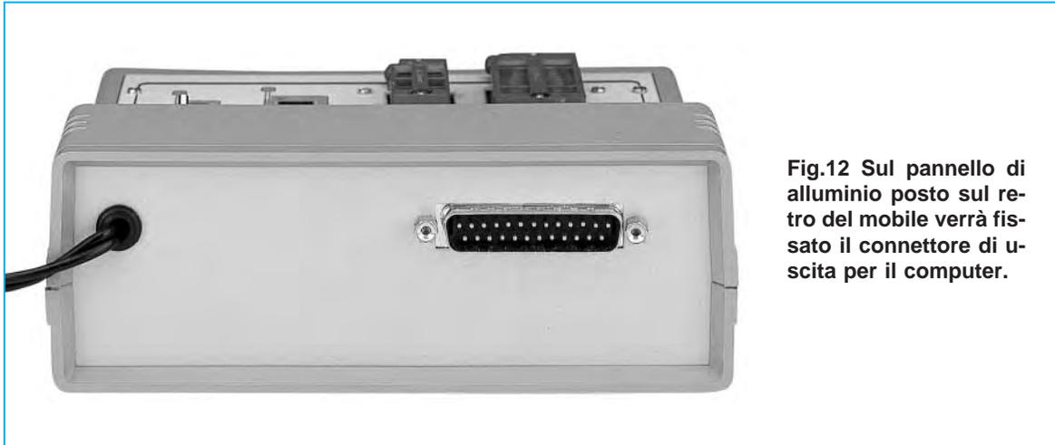
**Fig.12** Sul pannello di alluminio posto sul retro del mobile verrà fissato il connettore di uscita per il computer.
