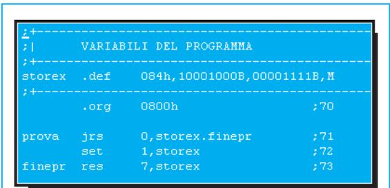
Fig.3 In questa figura vi facciamo vedere come appariranno sul monitor le cinque righe delle istruzioni del 1° esempio. Come potete notare, a fianco di ogni istruzione abbiamo riportato dopo il ; il numero della relativa riga.
