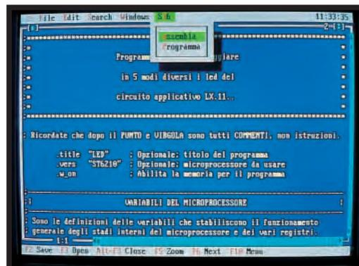
Fig.6 Una volta salvate le modifiche con F2 (vedi fig.5) dovete riassemblare tutto il programma. Premete **Alt+T** e quando apparirà questa finestra pigiate il tasto **A**. L'assemblaggio dura solo pochi secondi.
