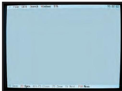
**Fig.13** Quando sul monitor appare la finestra dell'Editor potete premere i tasti **ALT+F** poi **F3** e vedrete apparire tutti i files con l'estensione **.ASM**.
