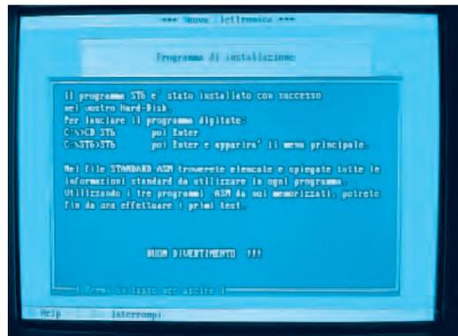
Fig.13 Solo quando sul monitor apparirà la scritta **BUON DIVERTIMENTO !!!** potrete premere un qualsiasi tasto per uscire. Per richiamare il programma dovrete scrivere **C:\>ST6** poi **C:\ST6>ST6** ed Enter.
