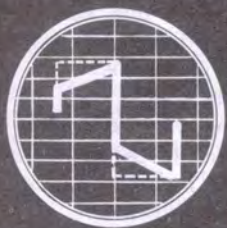
Fig. 6 Quando un'amplificatore attenua invece le frequenze ALTE sull'oscilloscopio appare una traccia simile a questa.
