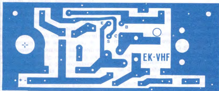
Fig. 2 Circuito stampato a grandezza naturale, visto dal lato della pista di rame.
