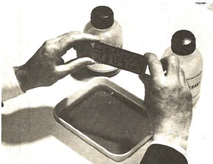
Fig. 9 - Dopo 15 minuti circa potete togliere la bassetta dal bagno, e controllare in trasparenza se tutto il circuito è ben distinto. Se appaiono eventuali zone opache, immergete nuovamente la bassetta per completare l'incisione.
