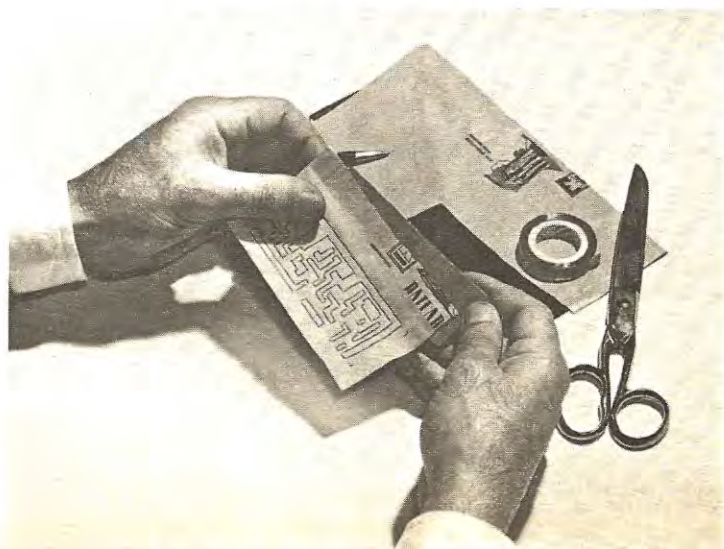
Fig. 4 - Dopo di ciò appoggiate sulla superficie del rame un foglio di carta carbone. Sopra a questa ovviamente andrà collocata la carta lucida con il disegno del circuito stampato che precedentemente avete ricopiato dalla rivista.
