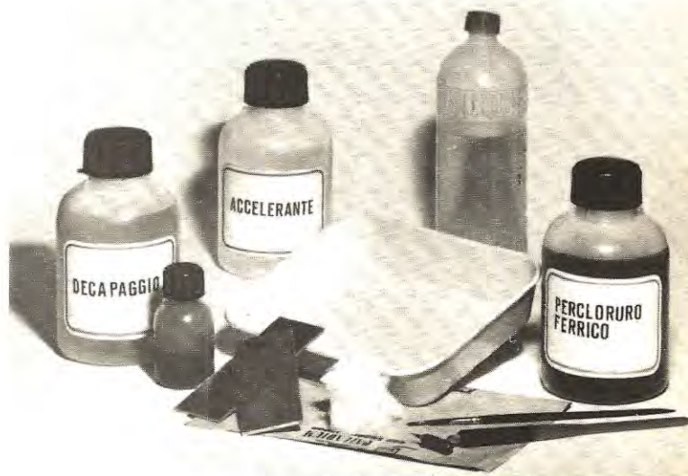
Fig. 12 - L'occorrente per preparare un qualsiasi circuito stampato si riduce praticamente a quanto presentato in questa fotografia, una bacinella in plastica, una bacchetta in plastica, quello di decapaggio, l'inchiostro protettivo, una bottiglia di alcool denaturato, della carta carbone, un pennello e pennino da normografo, e logicamente delle piastre di bachelite ramate.
