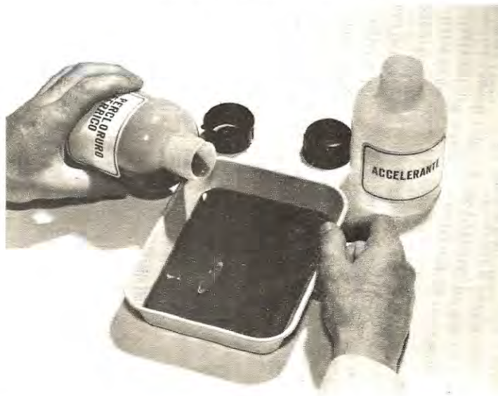
Fig. 7 - In una bacinella di plastica versate ora la soluzione concentrata di percloruro ferrico e di accelerante. Come già precisato nell'articolo la proporzione dei due liquidi non influisce sulla buona riuscita, quindi si può variare senza alcun inconveniente.
