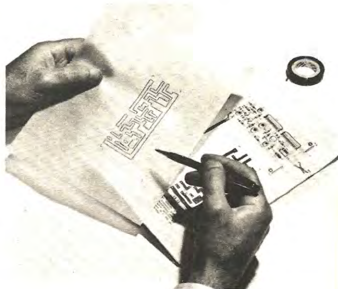
Fig. 2 - Terminata l'operazione, prima di procedere, controllate che il disegno sia stato copiato integralmente, inoltre non dimenticate di contrassegnare il foglio « lato rame » per evitare di riportarlo sulla lastra alla rovescia.
