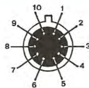
Fig. 1 Lo zoccolo dell'integrato TAA 300 è provvisto di 10 terminali. Il piedino n. 1 (visto dal di sotto) è il primo a destra prendendo come riferimento la tacca sporgente dal corpo.
