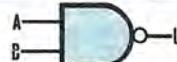
Fig. 4 La logica tipo AND si trova normalmente accoppiata con un INVERTER in uscita. Poiché anche questa è quella che si utilizza comunemente in ogni circuito, viene denominata logica NAND per non dover sempre indicare AND con INVERTER in uscita.
