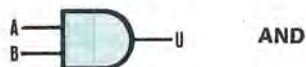
Fig. 1/B Le logiche tipo AND, a differenza di quelle OR, utilizzano un disegno leggermente diverso, che non può comunque lasciare dubbi sulla sua identità. I terminali A.B corrispondono sempre alle due entrate e quello U alla uscita.
