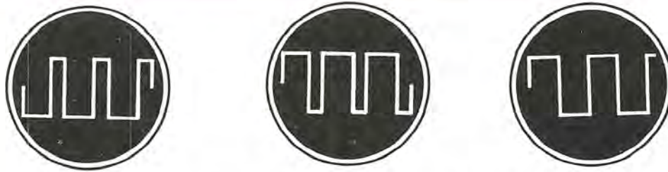
Fig. 8 Il trimmer R1 serve rendere perfettamente lineare la forma d'onda. Se avete un oscilloscopio potrete ruotare il cursore di R1 in modo da ottenere sullo schermo, la forma d'onda visibile a destra. I disegni di sinistra e al centro mostrano l'onda quadra quando R1 non è regoiato nella sua giusta posizione. Se non possedete un oscillografo, procedete come spieghiamo in articolo.
