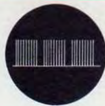
Impulsi a massimo segnale. Le righe verticali coprono quasi al completo lo schermo.
