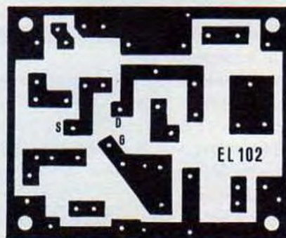
Fig. 2 Disegno a grandezza naturale del circuito stampato che il lettore dovrà autocostruirsi per la realizzazione di questo preamplificatore.
