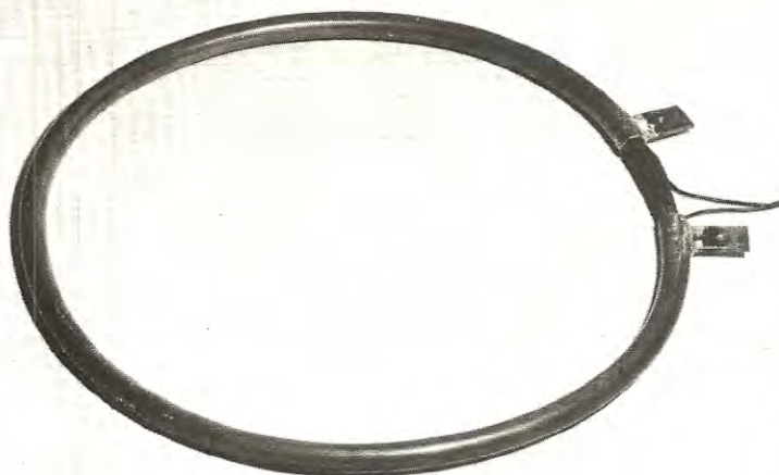
Fig. 2. La bobina esploratrice L1 deve risultare avvolta entro un tubo di rame come vedesi in questa foto. Considerata la difficoltà di realizzazione abbiamo provveduto a farci preparare questa sonda esploratrice da industrie del ramo. Il costo della sonda pretrata è di L. 2.500 più spese postali.
