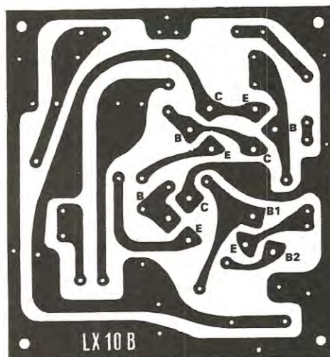
Fig. 6. Circuito stampato a grandezza naturale dello stadio finale di BF e del generatore di nota costituito dal transistor unigiunzione TR3.
