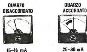
Fig. 1 A Controllando l'assorbimento del collettore del transistor oscillatore potremo stabilire, dalla corrente che scorre in esso, se questo funziona in modo corretto. Togliendo il quarzo l'oscillatore dovrebbe assorbire circa 15-16 mA. Se assorbisse una corrente inferiore dovremo ridurre il valore della resistenza R1 portandolo da 18.000 a 15.000 ohm. Se assorbisse una corrente superiore occorrerà aumentare il valore di R1 a 22.000 ohm. Inserendo il quarzo e ruotando il nucleo della bobina o il compensatore posto in parallelo a L1, constateremo che, quando l'oscillatore eroga alta frequenza, la corrente di collettore salirà dai 15-16 mA iniziali ai 25-30 mA. Se otterremo condizione inversa, cioè un maggior assorbimento senza il quarzo e minor assorbimento quando l'oscillatore eroga AF, significa che la resistenza R1 è di valore troppo basso.
