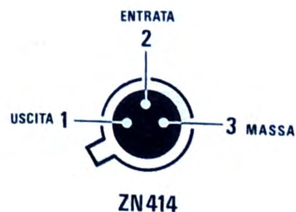
Fig. 2 I tre terminali che fuoriescono dal loro involucro risultano disposti nel seguente ordine (vedi tacca di riferimento) 1 = uscita segnale rivelato, 2 = entrata del segnale da amplificare in AF, 3 = massa.
