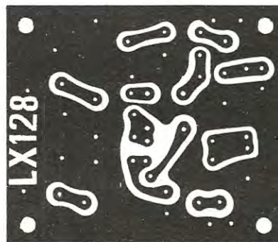
Fig. 2 Circuito stampato a grandezza naturale necessario a ricevere tutti i componenti di questo preamplificatore AF per i 144-146 MHz.
