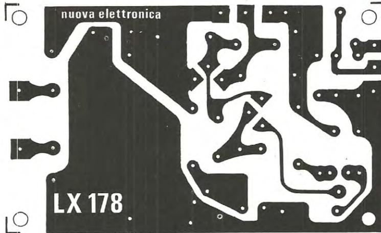
Fig. 3 Circuito stampato a grandezza naturale dell'alimentatore.
