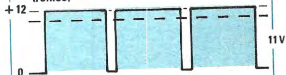
Fig. 6 Se noi interrompiamo ad intervalli regolari l'erogazione di tale tensione in modo che il tempo di pausa risulti minimo, l'effetto che otterremo sul carico sarà simile a quello fornito da una tensione continua di 11 volt.
