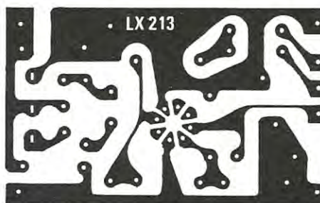
Fig. 11 Disegno del circuito stampato a grandezza naturale.
