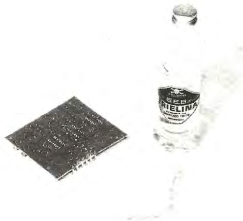
Fig. 2 Se lo stagno utilizzato contiene un disossidante di pessima qualità, prima di alimentare il circuito, pulite tutta la superficie passandovi sopra con un batuffolo di cotone imbevuto di trielina. Qualsiasi altro solvente, alcool, benzina ecc. servirà solo ad imbrattare maggiormente il circuito.
