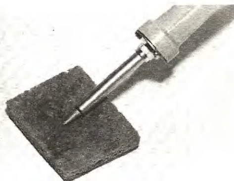
Fig. 4 Per pulire il saldatore, non limate mai la punta, bensì sfregatela sopra un pezzo di feltro, spugna o altro panno imbevuto in acqua comune.
