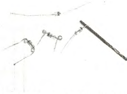
Fig. 9 Prima di inserire sullo stampato i diodi zener, è consigliabile attorcigliarne i terminali in modo da ottenere due o tre spire. Questo accorgimento impedirà al diodo di surriscaldarsi.
