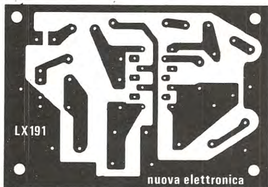
Fig. 3 Circuito stampato relativo all'amplificatore ad alimentazione singola.
