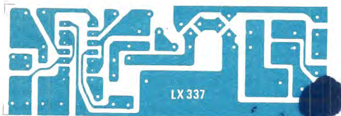
Fig. 4 a sinistra. Circuito stampato a grandezza naturale necessario per ricevere i componenti del trasmettitore.
