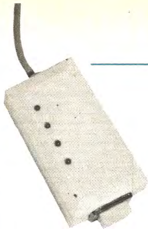
Fig. 1 Il preamplificatore-miscelatore descritto in questo articolo andrà applicato direttamente sul palo di sostegno delle antenne sfruttando come ingressi per tali antenne i quattro cavi coassiali di sinistra. I tre cavi coassiali di destra potranno invece utilizzarli per collegarvi l'antenna VHF oppure quella UHF per il 2° programma RAI. Se quest'ultima antenna dispone di preamplificatore dovremo utilizzare il solo cavo coassiale posto al centro lasciando inutilizzato il rimanente.
