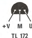
Fig. 1 Disposizione dei terminali (visti da sotto) del sensore ad effetto di Hall.
