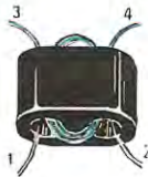
Fig. 3 I trasformatori T1-T2 di accoppiamento li realizzeremo avvolgendo dentro ad un nucleo ferrocube le spire richieste
