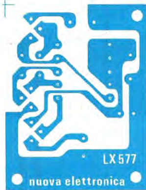
Fig. 2 Disegno a grandezza naturale del circuito stampato.
