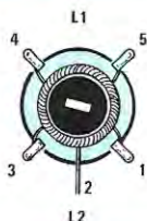
Fig. 13 Nel collegare la bobina L1-L2 cercate di non invertire i terminali del primario con quelli del secondario. Il filo della presa centrale vi servirà da riferimento.
