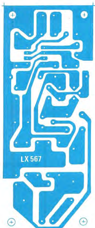
Fig. 7 Disegno a grandezza naturale del circuito stampato del trasmettitore ad onde convogliate. Come sempre il circuito vi verrà fornito già forato e completo di disegno serigrafico.
