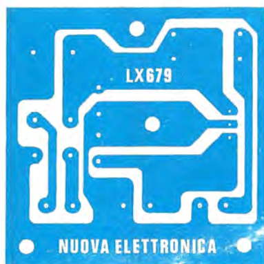
Fig. 11 Disegno a grandezza naturale del circuito stampato.
