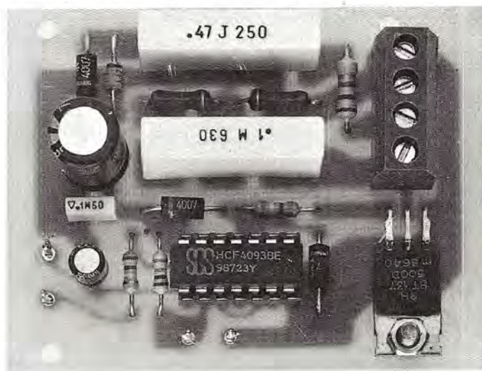
Fig.4 Foto ingrandita del lampeggiatore a 220 volt. Si notino i due condensatori al poliestere da 250 e 630 volt lavoro e la morsettiera per il cordone d'ingresso e di uscita.
