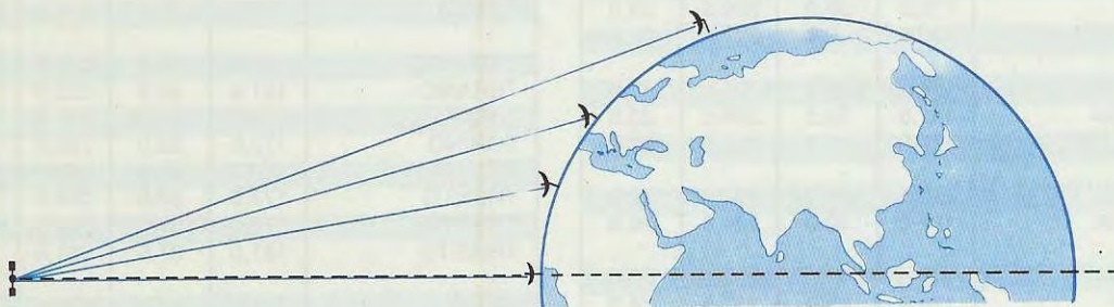
Fig.7 Il parametro più importante da conoscere per centrare un satellite è l'Elevazione, cioè i gradi di inclinazione della parabola rispetto al suolo. In pratica, sulla linea dell'Equatore, questa andrà posta in posizione orizzontale, mentre, più ci allontaneremo verso il Nord, più la dovremo abbassare. Perciò, per chi si trova nel Sud Italia (Latitudine 37° parallelo), l'antenna dovrà avere una inclinazione diversa rispetto a chi si trova nel Nord Italia (Latitudine 47° parallelo).
