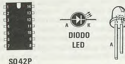
Fig.6 Connessioni dell'integrato S0.42P visto da sopra e del diodo led. Da notare il terminale A più lungo rispetto al K.
