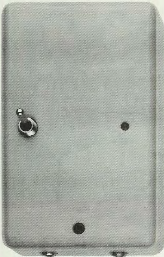
Fig.2 Foto del mobiletto plastico utilizzato per contenere il circuito stampato e la pila di alimentazione.
