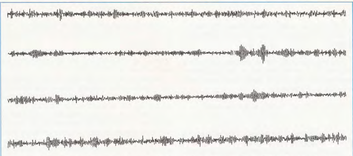
Fig.3 La sensibilità di questo sismografo è così elevata da permettere di rilevare anche le più microscopiche vibrazioni della terra. Perciò anche predisponendolo per una sensibilità media, sulla carta non vedremo mai una linea perfettamente rettilinea, ma tanti sciami di oscillazioni provocate normalmente da variazioni della pressione atmosferica, da mareggiate, frane, esplosioni di mine, assestamenti del sottosuolo, ecc.
