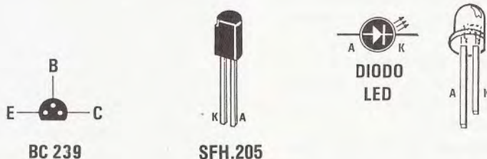
Fig.6 Connessioni del transistor BC.237 visto da sotto, del fotodiode SFH.205 e del led.
