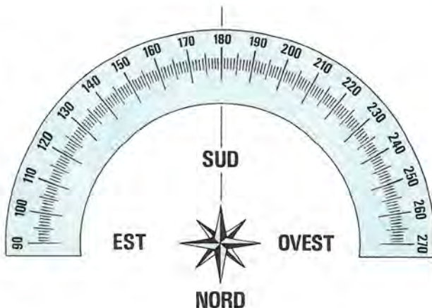
Fig.3 Anche se la posizione di un satellite viene indicata in gradi Est-Ovest rispetto al meridiano di Greenwich, per la ricerca si preferisce utilizzare i gradi di Azimut. 90 gradi è l'Est, 180 gradi è il Sud e 270 gradi è l'Ovest. Nella nostra tabella troverete i gradi di Azimut per ciascun capoluogo di provincia.
