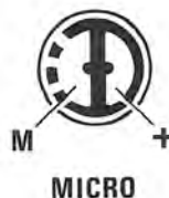
Fig.5 Connessioni viste da sopra dell'integrato TBA.820 e del microfono preamplificato visto da dietro. La pista Massa di questi microfoni risulta elettricamente collegata all'involucro metallico, mentre la pista + risulta isolata.
