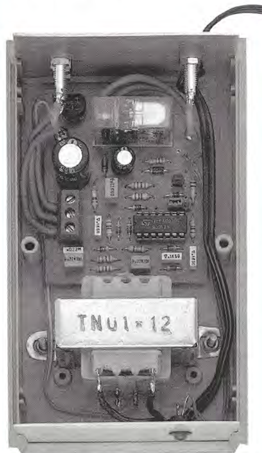
Fig.5 Foto dello stampato e del trasformatore di alimentazione già fissati all'interno del mobile plastico.
