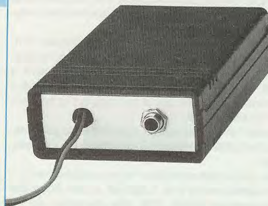
Fig.8 Sul pannello posteriore fisseremo il solo connettore femmina Jack per il microfono magnetico. Nel foro visibile a sinistra fuoriusciranno i due fili "rosso" e "nero" per i 12 volt dell'alimentazione. Volendo è possibile applicare su tale pannello due boccole isolate in sostituzione dei due fili.
