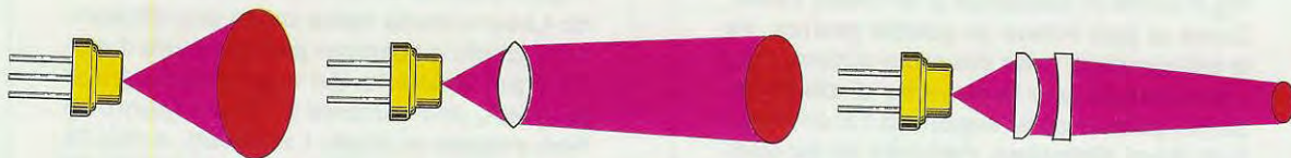
Fig.6 Come già accennato, il fascio emesso da un Diodo Laser ha un'ampia divergenza, pertanto senza una appropriato obiettivo non riusciremo mai ad ottenere un "piccolissimo" punto luminoso. Gli obiettivi provvisti di più lenti focalizzeranno meglio di ogni altro il fascio Laser.
