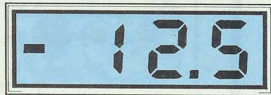
Fig.10 Tarare questo termometro è molto semplice perchè a differenza di altri che necessitano di termometri di paragone e di temperature campione, questo lo si tara misurando la tensione che appare sul terminale U della sonda LM.35. Se con il tester rileveremo una tensione di 108 millivolt "negativi" dovremo tarare il trimmer R9 fino a leggere -10,8, se leggeremo una tensione di 125 millivolt "negativi" tale trimmer lo dovremo tarare fino a leggere -12,5, mentre se rileveremo una tensione di 373 millivolt "positivi" lo tareremo fino a leggere 37,3 gradi.
