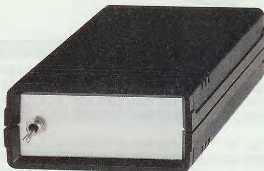
Fig.2 Sul pannello posteriore del mobile fisseremo il solo deviatore di accensione. Come visibile nella foto posta in alto a destra, nell'interno di questo mobile, oltre al circuito stampato, troveranno posto anche le pile di alimentazione.
