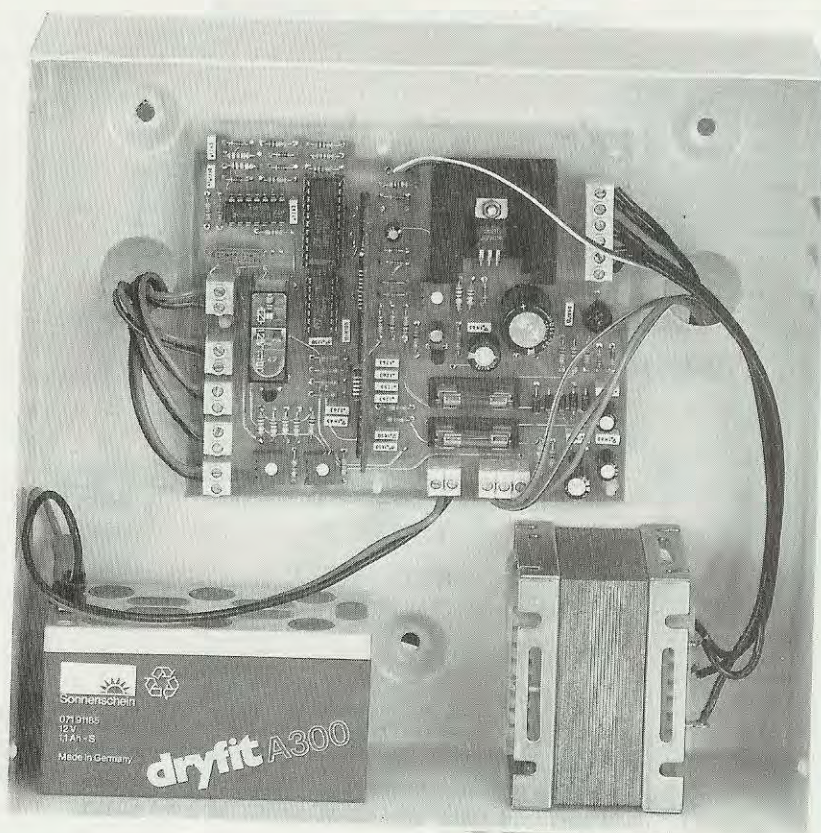
Fig.33 La scheda base LX.1084 verrà fissata nell'interno del mobile con quattro distanziatori plastici autoadesivi. In basso verrà applicata la Batteria e il Trasformatore di alimentazione.
