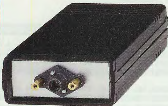
Fig. 1 Sul pannello frontale di questo PUN-TATORE a Diodo Laser troverà posto il supporto per l'obiettivo e le due torrette in ottone necessarie per sostenere il "tester ottico" quando ci accingeremo a tararlo per la sua massima potenza ( vedi fig.19 ).
