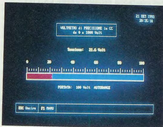
Fig.6 Se volete scegliere il fondo scala in manuale, dovrete premere F1 e successivamente i tasti funzioni F2-F3-F4-F5. Per ritornare in automatico pigiate il tasto F1.
