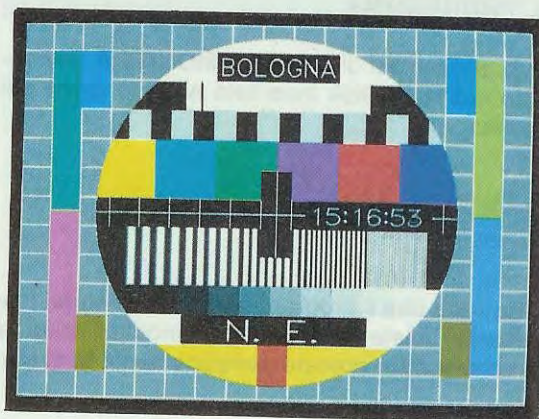
Fig.4 Con questo monoscopio potrete controllare se il monitor del vostro computer è ben linearizzato, se riproduce fedelmente i colori, se avete ben regolato il contrasto e la luminosità e se la pila interna non è esaurita. Se la vostra pila è già esaurita, noterete che l'orologio ritarderà ogni giorno.
