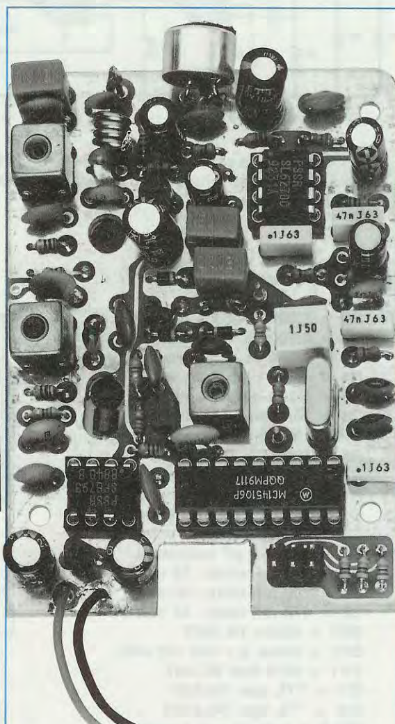
Fig.1 Foto notevolmente ingrandita del radiomicrofono FM a 4 canali. Le dimensioni reali del mobiletto con già inclusa la pila di alimentazione a 9 volt sono le seguenti: altezza 110 millimetri, larghezza 58 mm e profondità 20 mm. Il segnale di questo radiomicrofono si può captare ad una distanza di 400-500 metri nelle zone aperte e di 200-300 metri se questo viene collocato dentro un palazzo in cemento armato.
