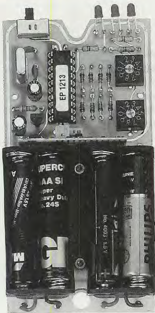
Fig.20 Foto del circuito stampato LX.1213 visto dal lato dei componenti. I terminali dei tre diodi led, come visibile anche in fig.18, andranno ripiegati a L per far fuoriuscire leggermente la testa di quest'ultimi dal mobile plastico.
