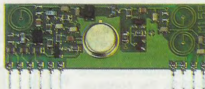
Fig.3 Questo modulo in SMD, utilizzato nello stadio trasmettente, è in grado di erogare 10 milliwatt sui 434 MHz. Aggiungendo esternamente due transistor (vedi fig.7) siamo riusciti ad ottenere più di 400 milliwatt.
