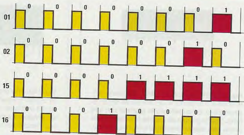
Fig.5 In questa figura riportiamo i codici binari che il trasmettitore invierà verso i ricevitori codificati 01-02-15-16. Per conoscere a quale numero decimale corrispondono questi 8 bit binari, vi consigliamo di consultare la tabella riportata a pag.381 del nostro HANDBOOK .
