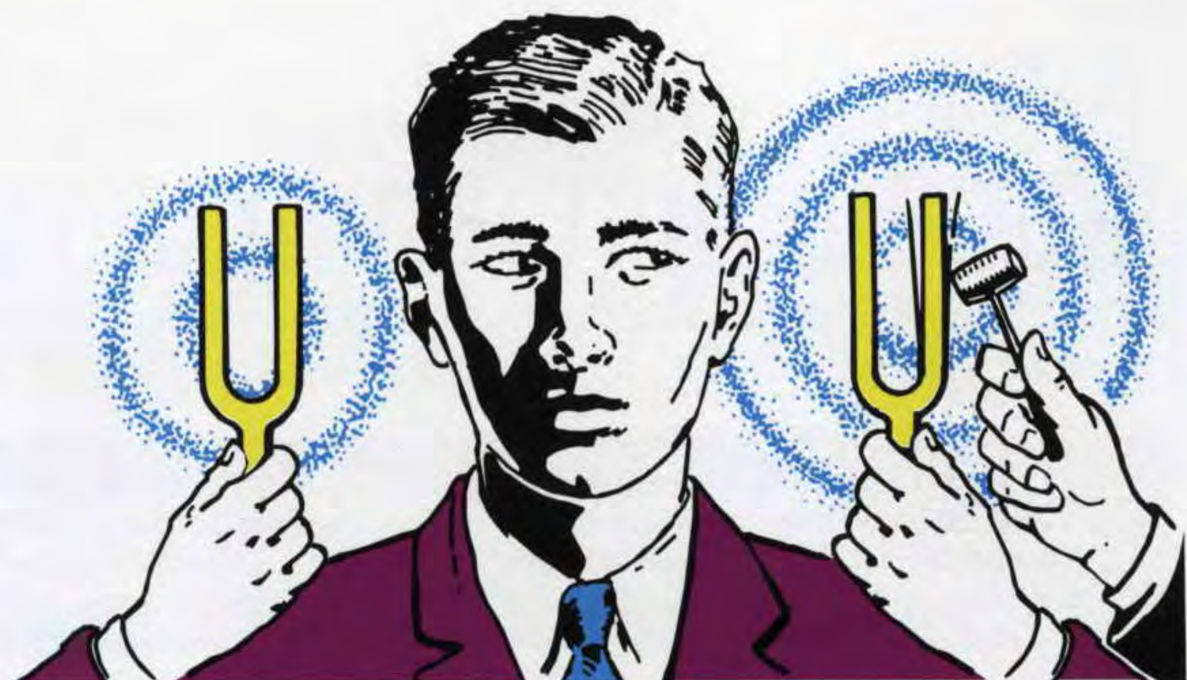
Fig.193 Facendo vibrare un Diapason con un martelletto, questo emetterà delle onde sonore che riusciranno a far vibrare un altro Diapason purché sia vicino ed accordato sulla stessa frequenza.
