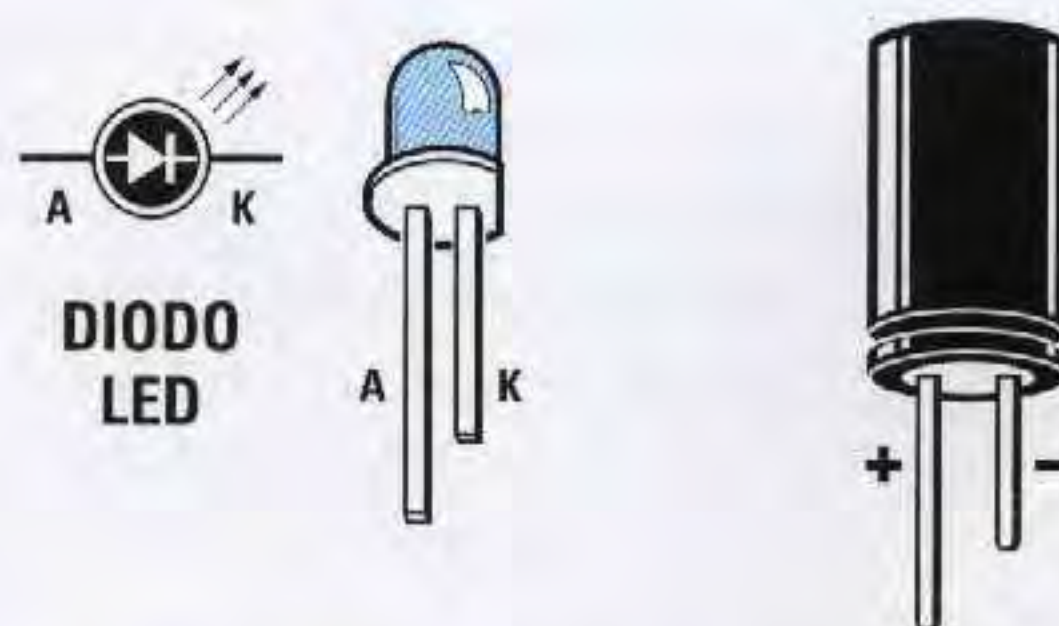
Fig.205 Il terminale più lungo del diodo led è l'Anodo, quello del condensatore elettro- litico è il "positivo".
