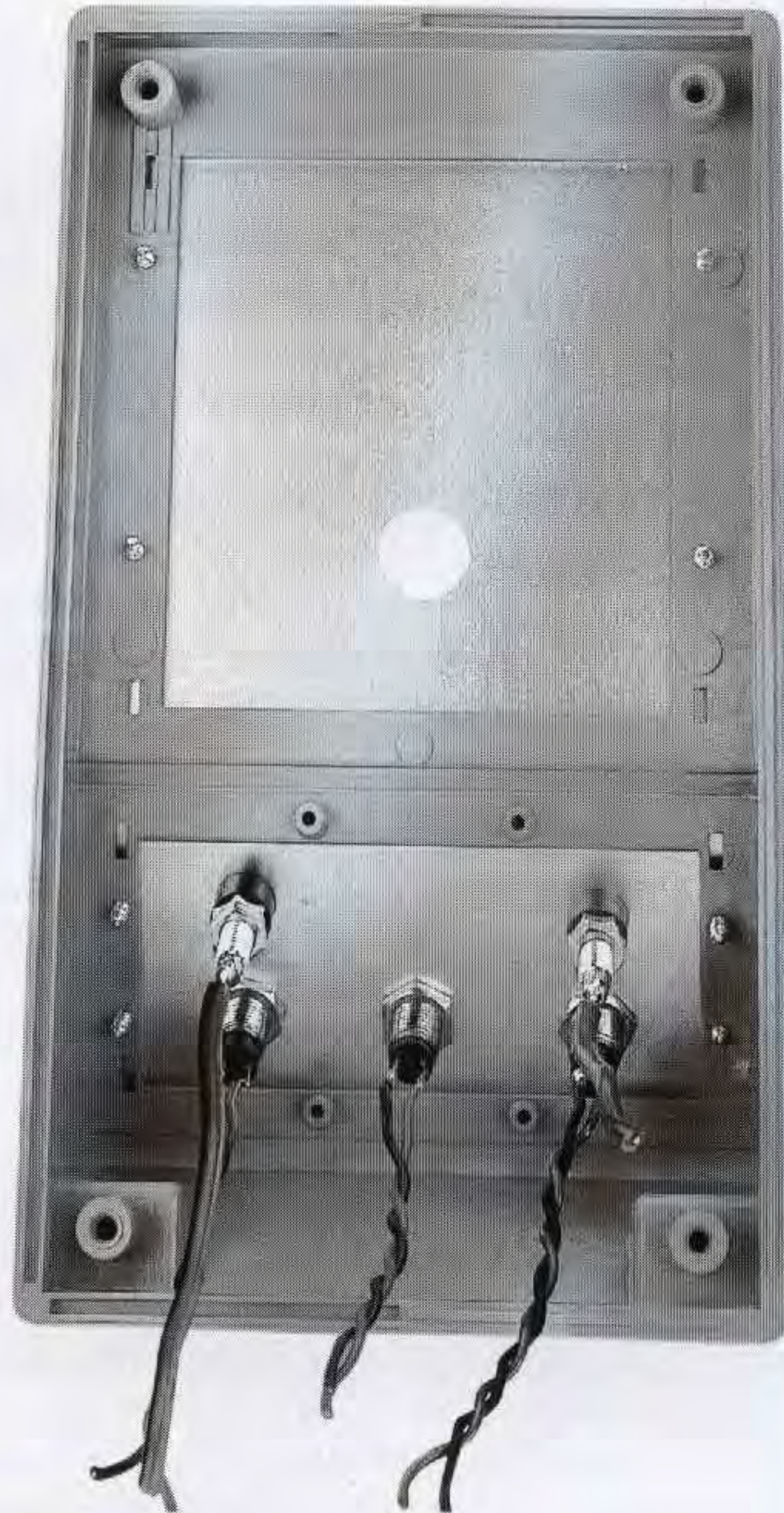
Fig.10 Nel pannello superiore, cioè quello inclinato sul mobile, fisserete le boccole d'ingresso e le tre gemme cromate contenenti i diodi led verde - giallo - rosso.
