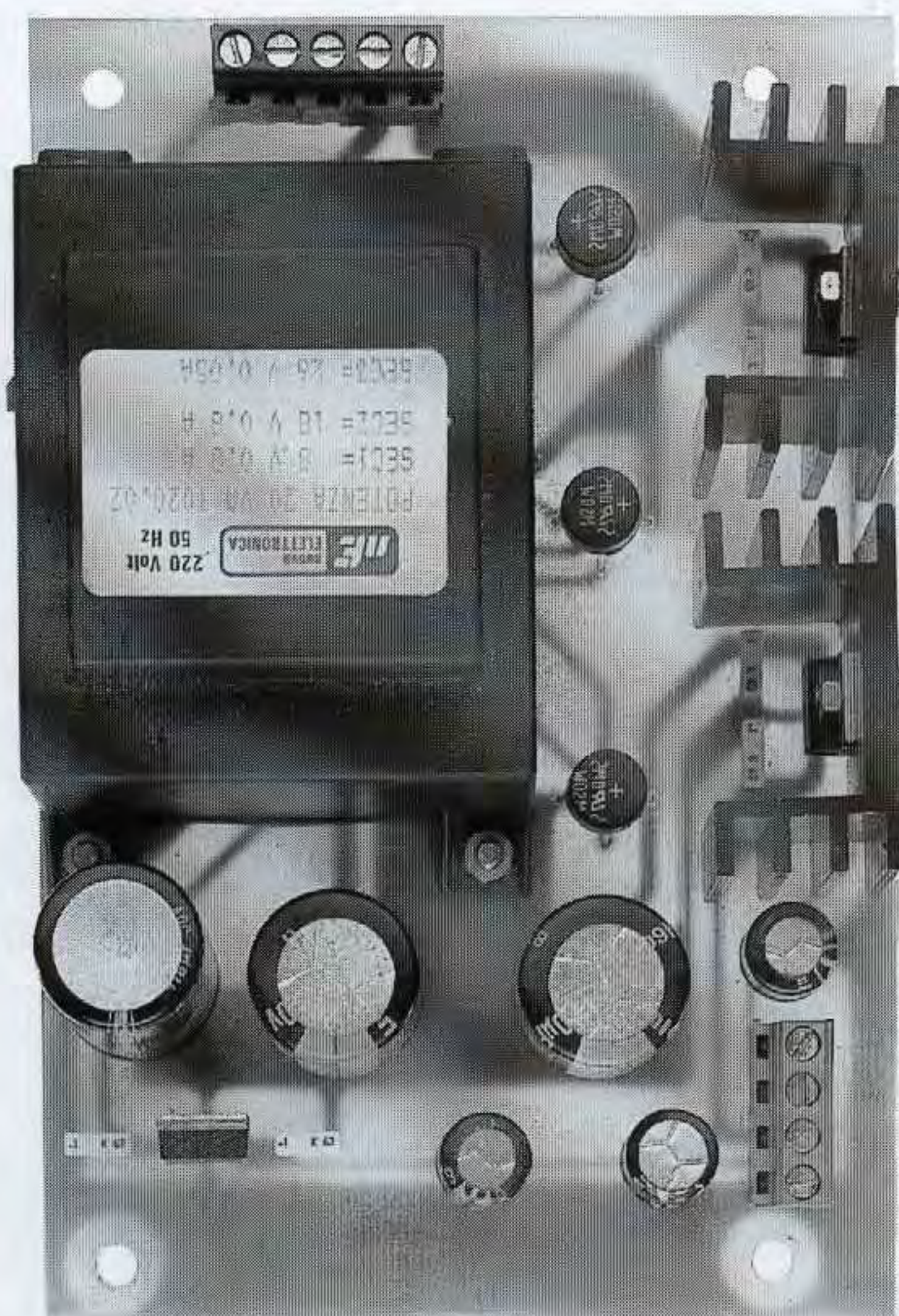
Fig.17 Foto dello stadio di alimentazione. L'aletta di raffreddamento andrà applicata solo sui due integrati siglati IC2 - IC3.
