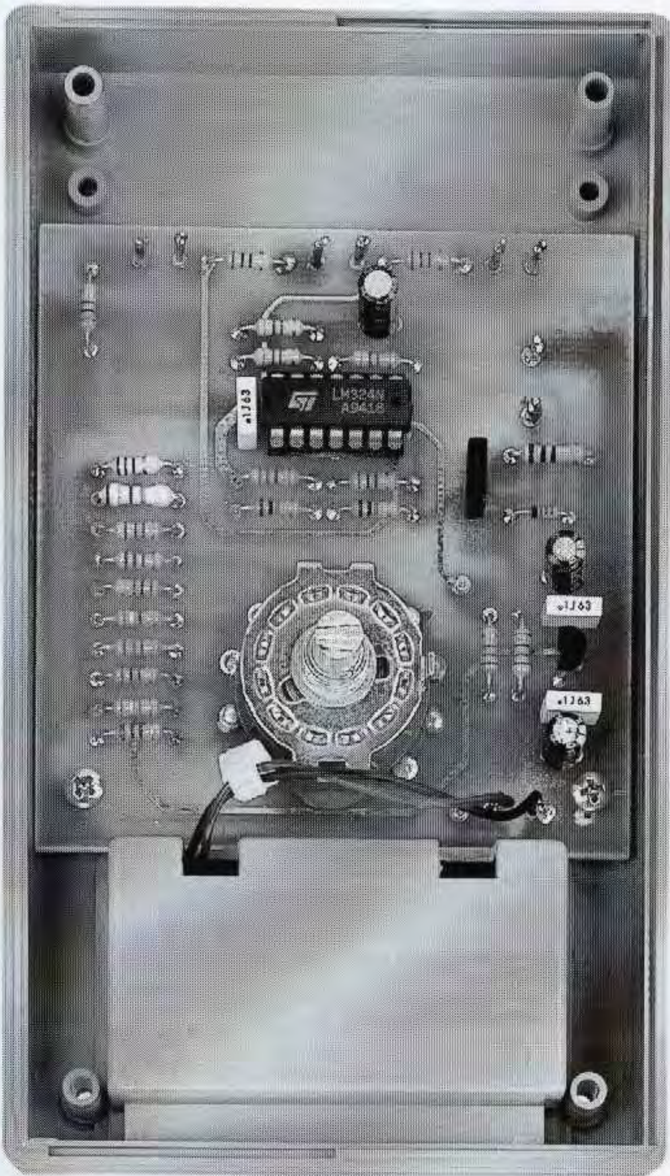
Fig.6 Foto del circuito stampato a doppia faccia con sopra montati tutti i componenti. Questo stampato verrà fissato all'interno del suo mobile plastico con le quattro viti autofilettanti che troverete nel kit. Le bocche d'ingresso ed i diodi led verranno fissati sul pannello in alluminio del coperchio (vedi fig.10).
