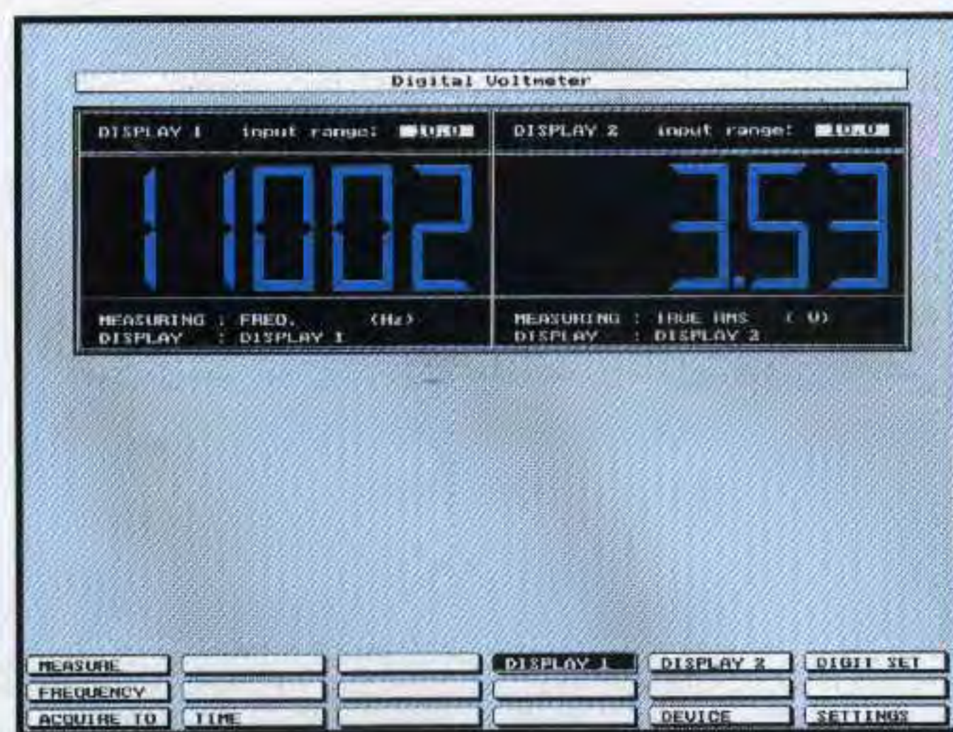
Fig.14 Se volete che uno dei due display vi legga la Frequenza, dovete andare su Mea- suring , pigiare Enter e scegliere la riga con la scritta Freq.
