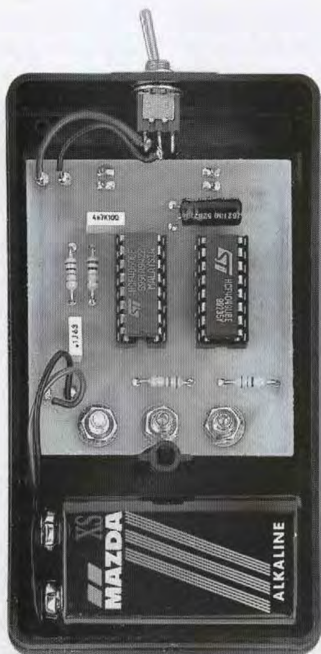
Fig.7 Nel vano posto in basso inserirete la pila di alimentazione da 9 volt.
