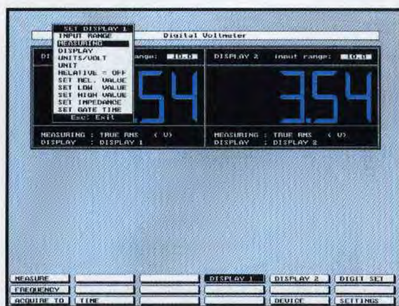
Fig.13 Se volete che uno dei due display vi indichi i volt p/p oppure i dBm o i watt dovrete andare su Measuring pigiare Enter e scegliere una di questa misure.
