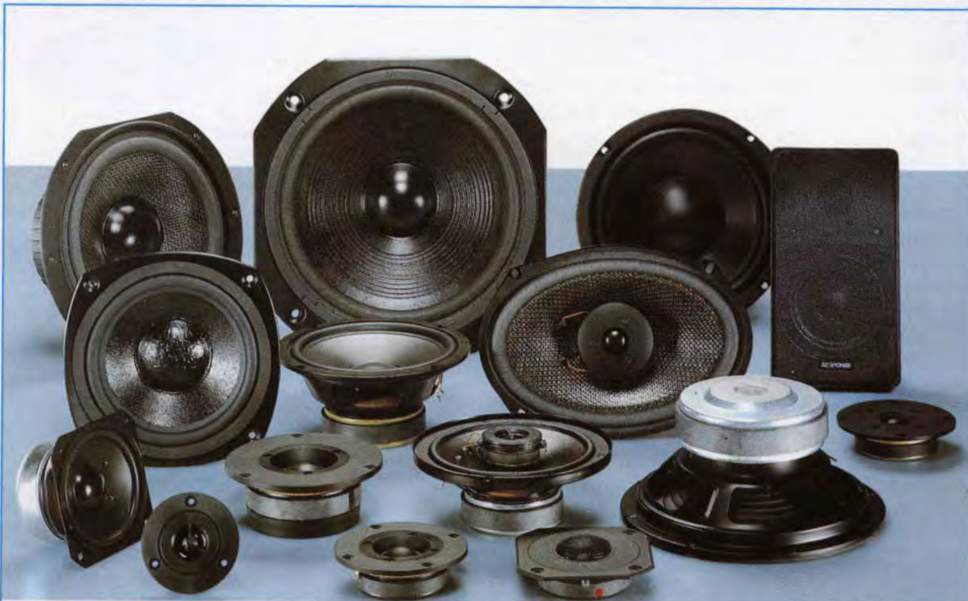
Fig.178 All'interno delle Casse Acustiche degli amplificatori hi-fi vengono inseriti due o tre altoparlanti di diverso diametro. Gli altoparlanti di diametro maggiore, chiamati Woofers , vengono utilizzati per riprodurre le sole note Basse, quelli di diametro intermedio, chiamati Midrange , per riprodurre le sole note Medie e gli altoparlante di diametro molto piccolo, chiamati Tweeter , per la riproduzione delle sole note Acute.
