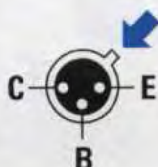
Fig.462 Se disponete di transistor metallici li potete tranquillamente usare. Nel disegno le connessioni CBE viste da sotto, cioè dal lato in cui i tre terminali fuoriescono dal corpo del transistor.
