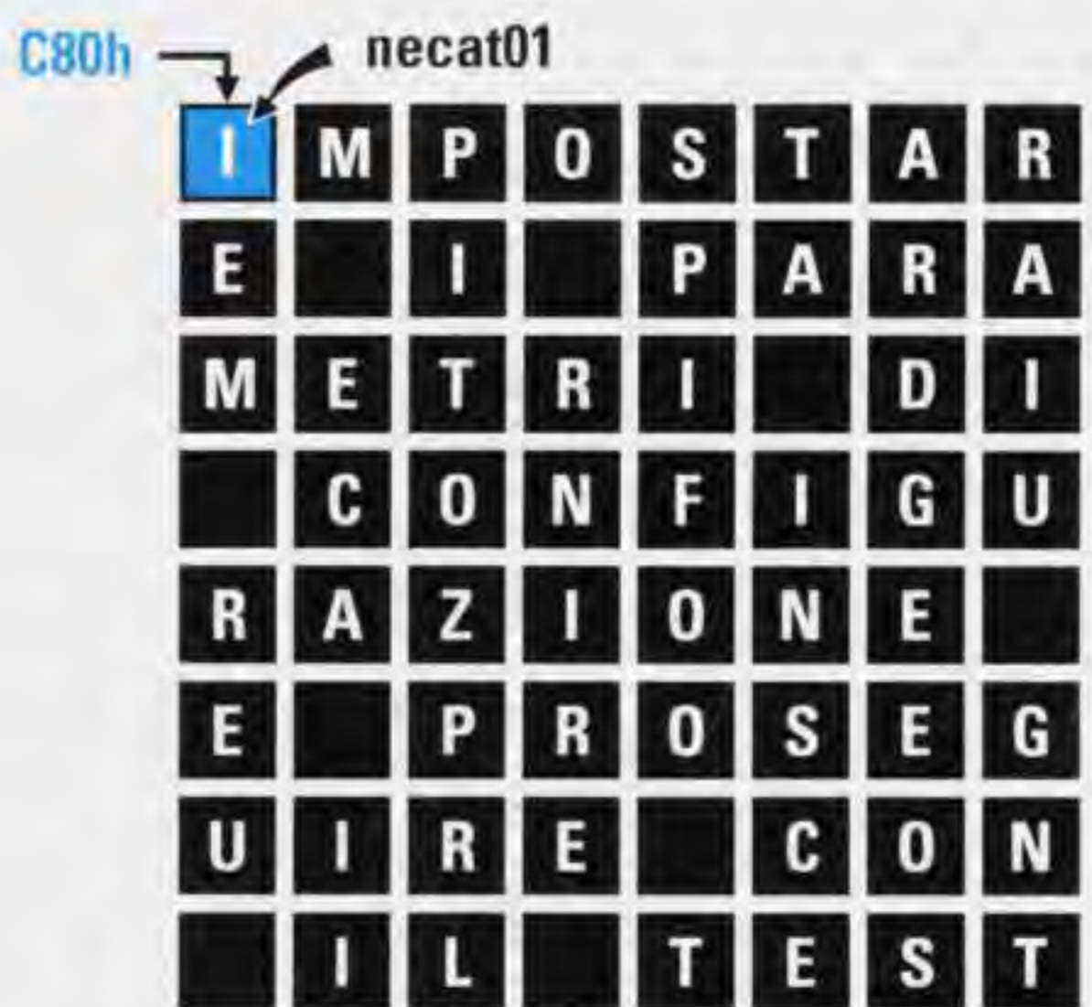
Fig.14 Infatti, inserendo .block 64-$%64 in una locazione di memoria divisibile per 64 senza resto, il testo viene posto nel blocco seguente sprecando l'area del primo.
