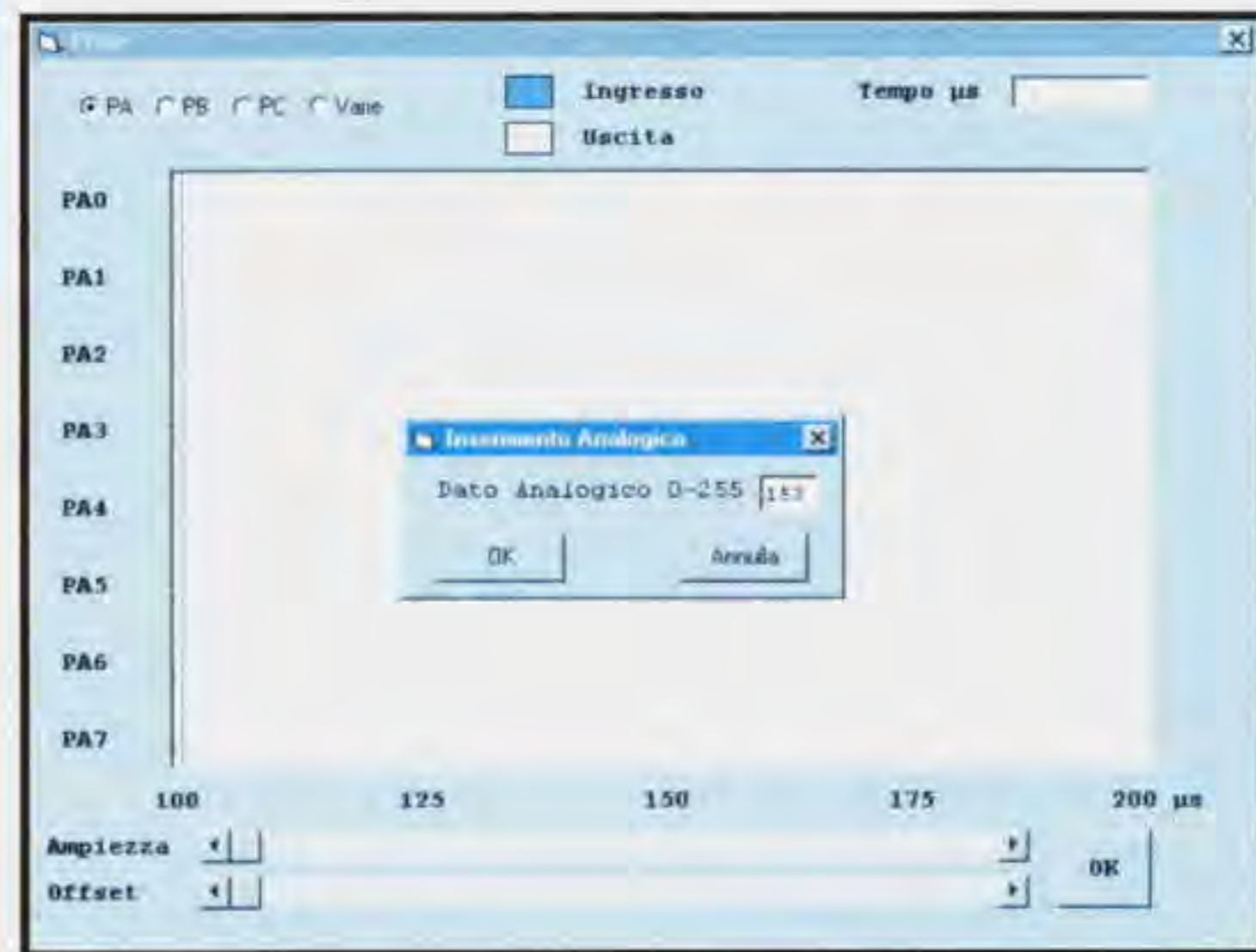
Fig.10 Se un piedino della porta è configurato Analog In , apparirà una finestra con un valore che potrete modificare.
