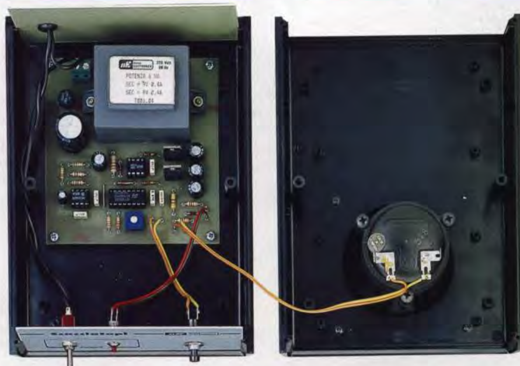
Fig.4 Il circuito stampato verrà fissato sulla base del mobile plastico con quattro viti autofilettanti e l'altoparlante Tweeter nel foro presente sul coperchio del mobile.
