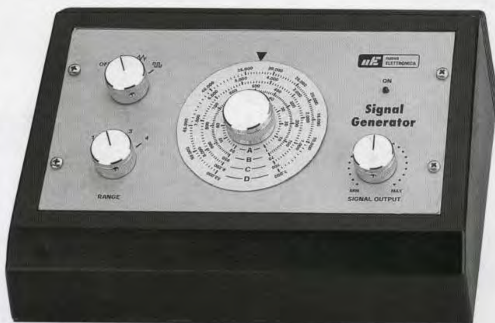
Fig.1 Foto del Generatore BF completo di mobile.
