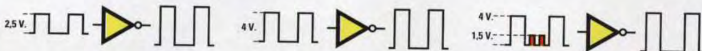
Fig.589 Una porta Inverter Triggerata riconosce come Livello logico 1 solo quei segnali che superano un livello di 2 volt, quindi se sugli ingressi giungono degli impulsi di disturbo che non superano una tensione di 2 volt, non vengono rilevati.
