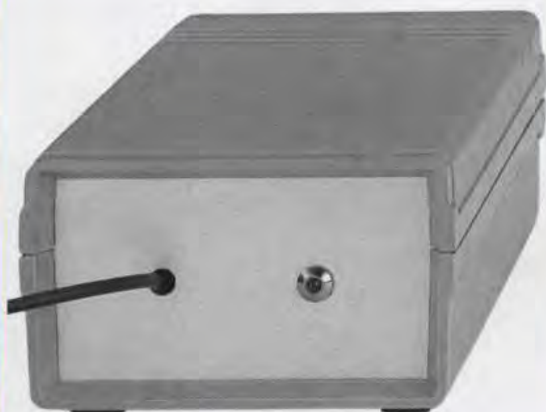
Fig.5 Potrete fissare il circuito nel piccolo mobile plastico che forniremo solo su richiesta. In questo mobile è presente il vano per contenere la pila da 9 volt.
