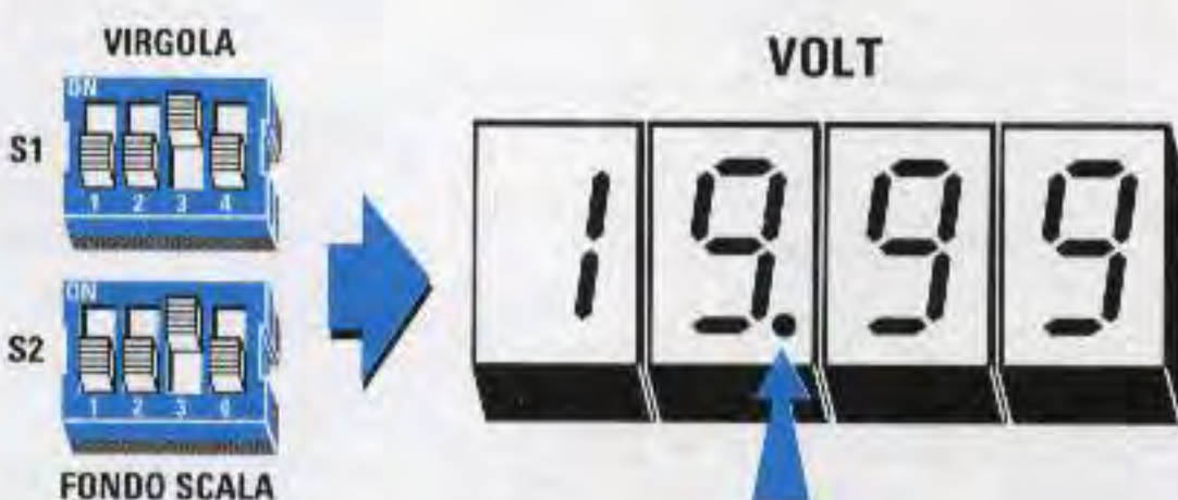
Fig.5 Spostando la terza leva di S1-S2 verso l'alto predisporrete il voltmetro per leggere 19,99 volt fondo scala.
