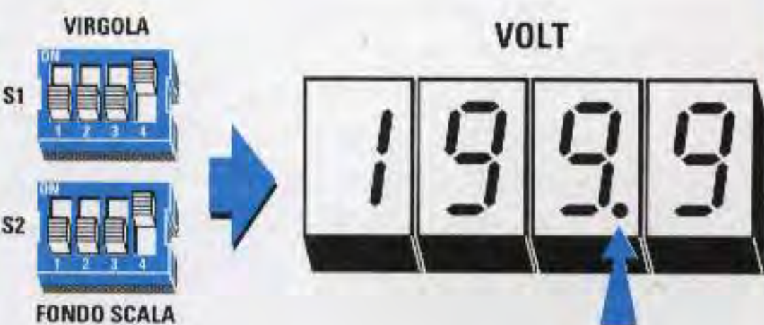
Fig.6 Spostando la quarta leva di S1-S2 verso l'alto predisporrete il voltmetro per leggere 199,9 volt fondo scala.
