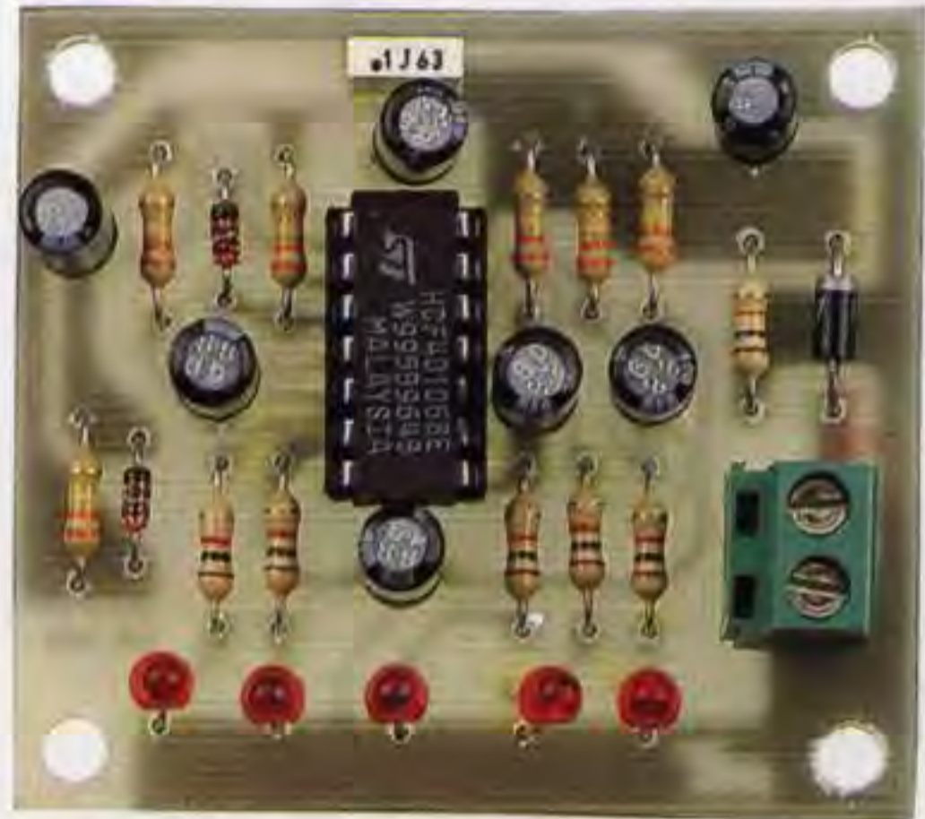
Fig.603 Foto del lampeggiatore sequenziale realizzato con un integrato digitale tipo 40106 contenente 6 Inverter triggerati.
