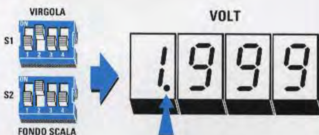
Fig.4 Spostando la seconda leva di S1-S2 verso l'alto predisporrete il voltmetro per leggere 1,999 volt fondo scala.
