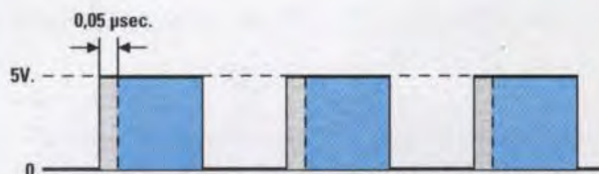
Fig.5 Per leggere sui display l'esatto valore del condensatore dovremo eliminare, in fase di taratura l'impulso di 0,05 µS presente su ogni impulso, diversamente lo stadio integratore ci fornirà una tensione maggiore di 0,35 volt.
