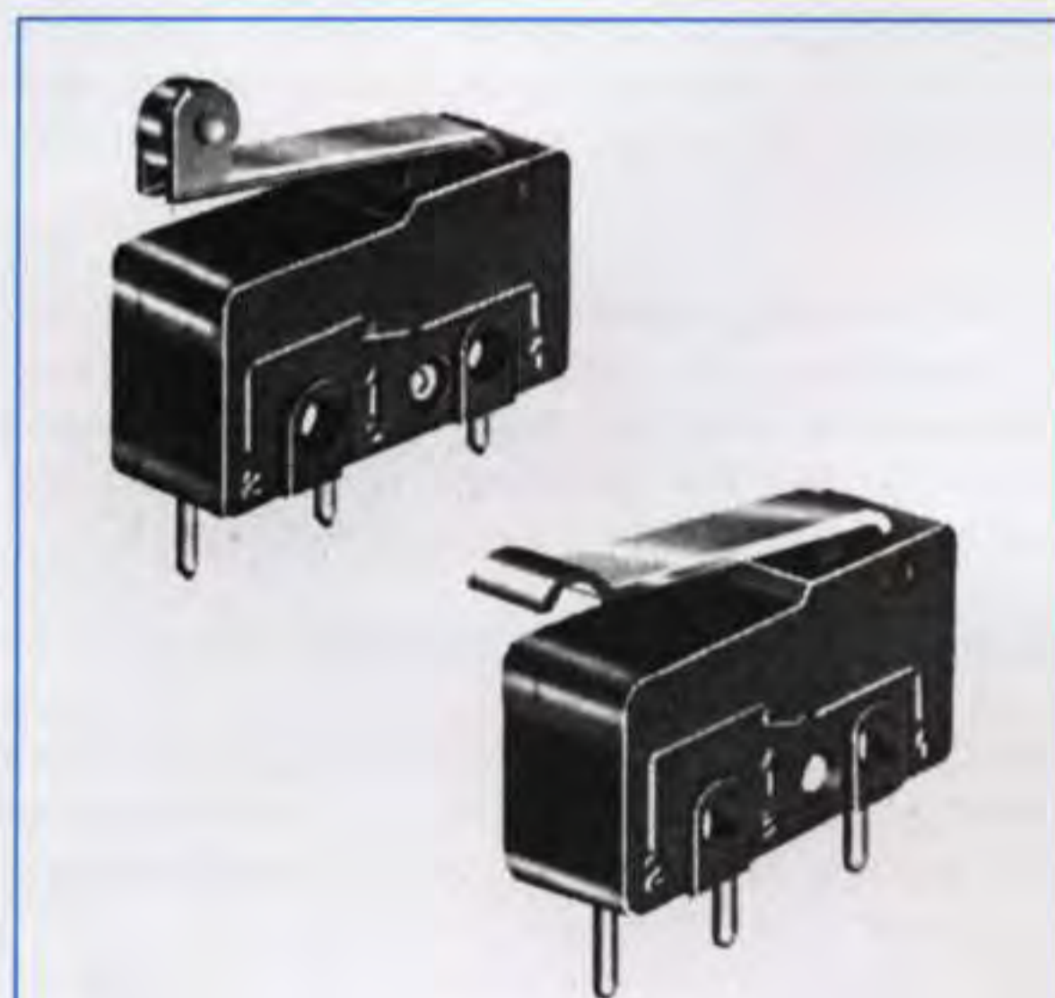
Fig.1 Tutti i microswitches meccanici sono provvisti di una leva che l'oggetto deve necessariamente toccare perchè si apra o si chiuda il suo contatto interno.
