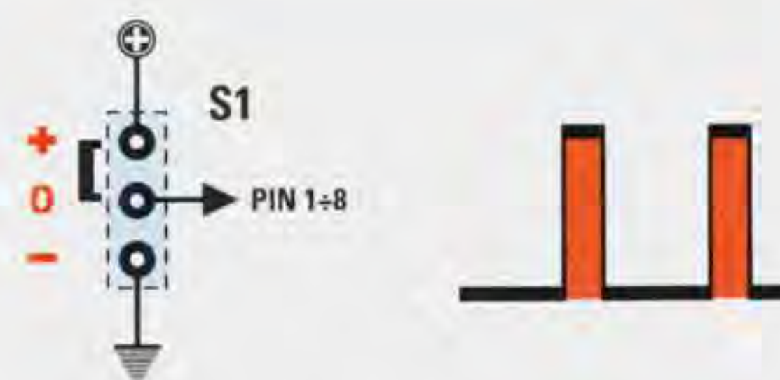
Fig.4 I piedini dell'encoder che collegherete al positivo tramite il dip-switch S1, faranno uscire due impulsi stretti.
