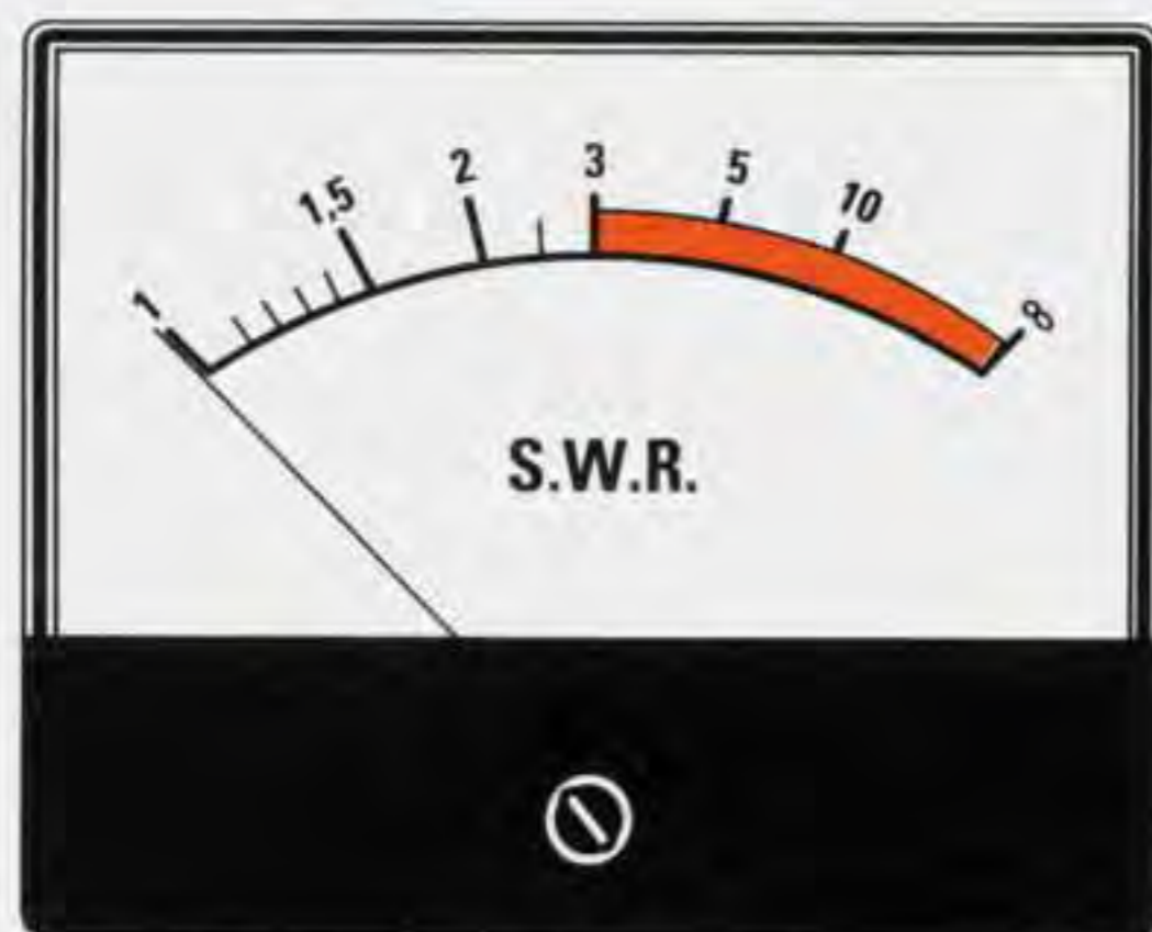
Fig.4 In tutti i rosmetri commerciali lo strumento di misura risulta graduato così come appare evidenziato in figura, cioè l'inizio scala non parte da 0 ma sempre dal numero 1.
