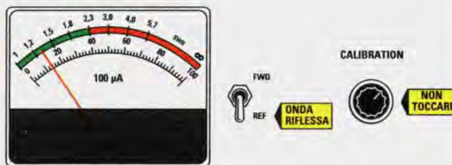
Fig.9 Dopo aver portato la lancetta dello strumento sul fondo scala (vedi fig.8), spostate il deviatore S1 sulla posizione "onda riflessa". Se l'antenna risulta perfettamente adattata vedrete la lancetta dello strumento deviare sull'inizio scala.
