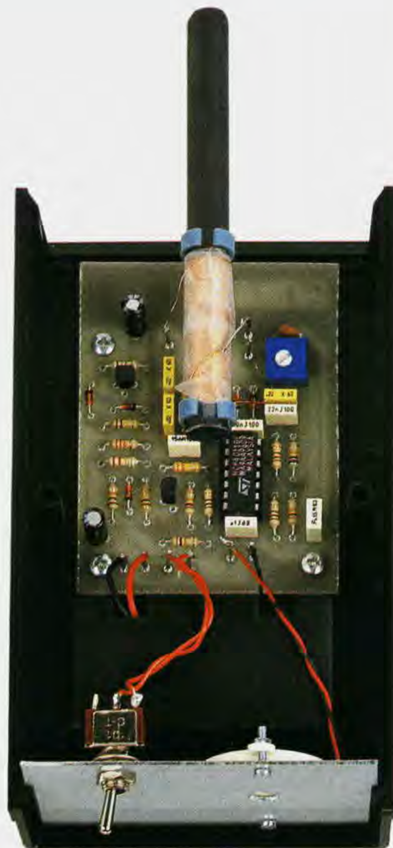
Fig.5 Il circuito va fissato all'interno del suo mobile plastico con tre viti autofilettanti. Nel vano del mobile visibile in basso andrà inserita la pila da 9 volt.
