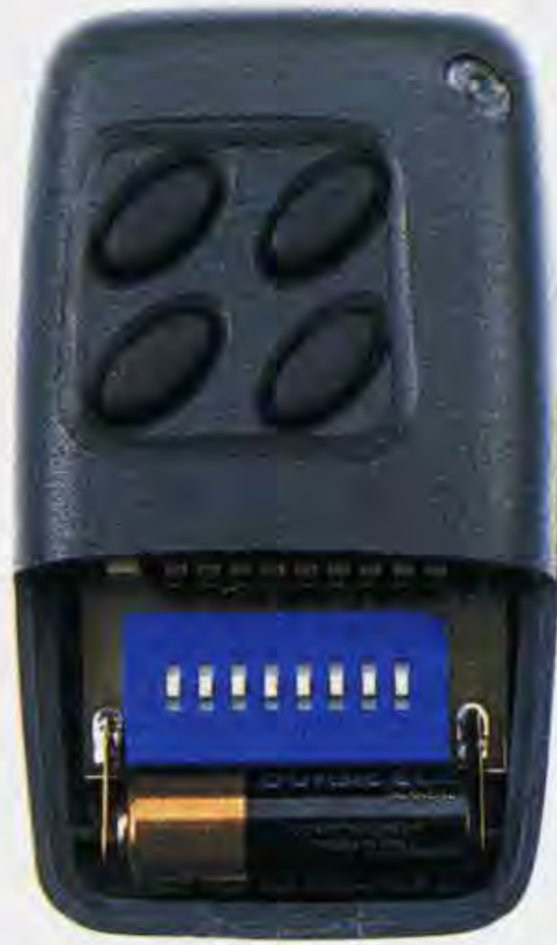
Fig.17 Il coperchio del mobile è suddiviso in due parti così da poter accedere agevolmente alla pila per sostituirla quando è scarica.
