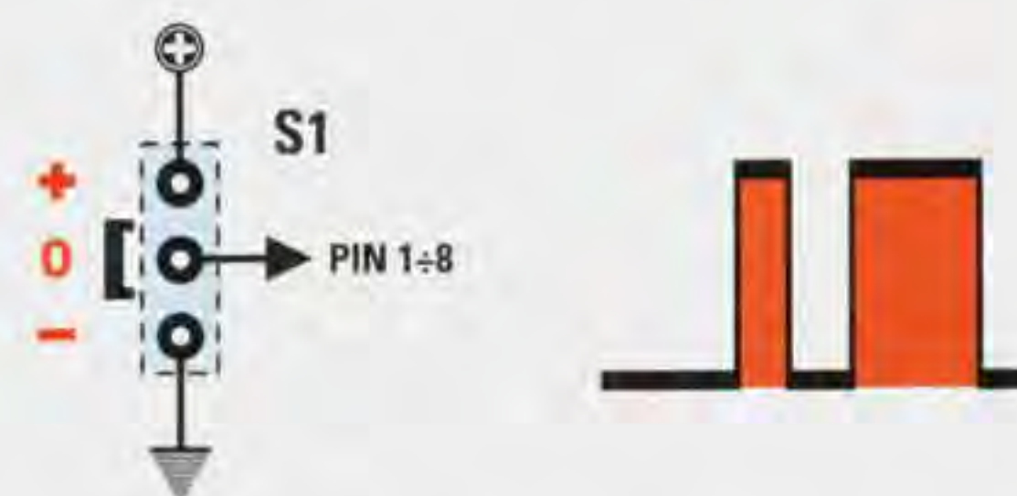
Fig.5 I piedini dell'encoder non collegati nè al positivo nè a massa, faranno uscire un impulso stretto e uno largo.
