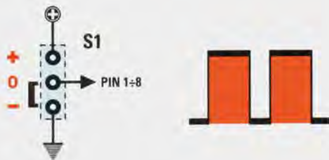
Fig.6 I piedini dell'encoder che collegherete a massa tramite il dip-switch S1, faranno uscire due impulsi larghi.
