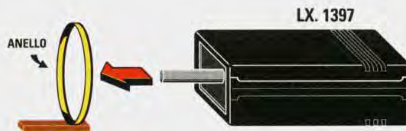
Fig.6 Avvicinando un anello metallico al nucleo ferrocube, appena questo entrerà sentirete la cicalina suonare.
