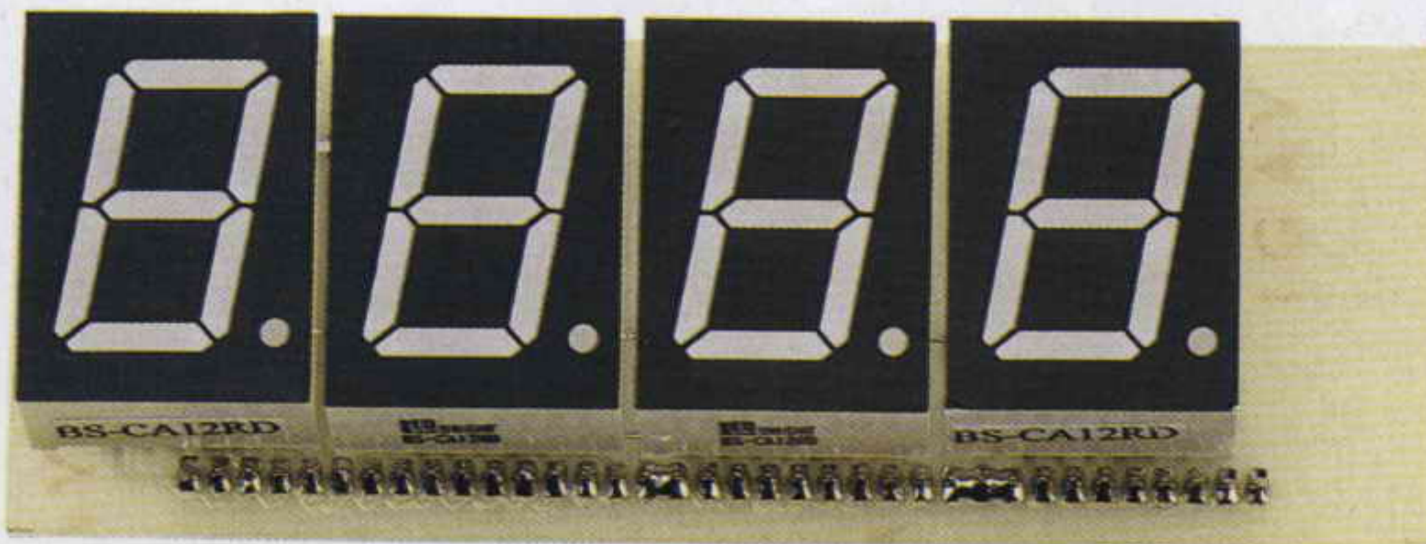
Fig.280 Il punto decimale dei Display va rivolto verso il connettore femmina.
