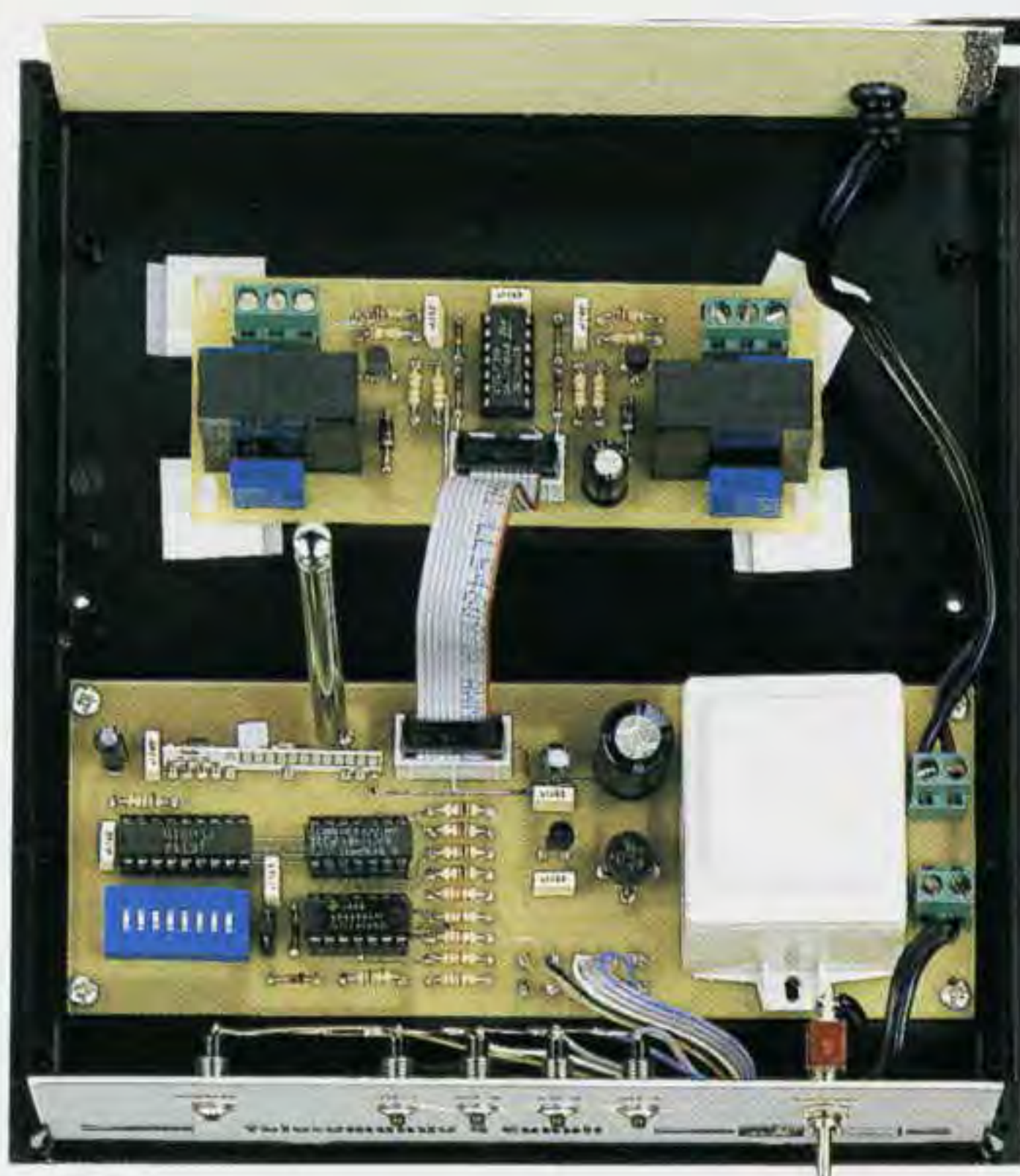
Fig.23 In questa foto potete vedere il circuito LX.1411 di fig.30 già fissato sul piano del mobile con quattro distanziatori plastici con base autoadesiva. La piattina cablata inserita nel kit vi servirà per collegare questa scheda con i due relè al connettore presente sul circuito stampato del ricevitore.
