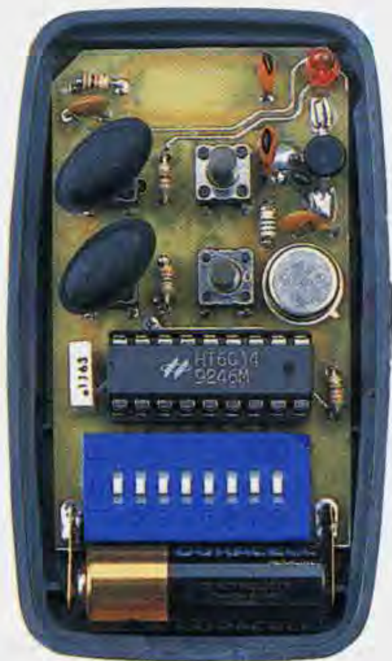
Fig.16 Dopo aver inserito il circuito all'interno del mobile, dovete applicare sui perni dei quattro pulsanti i relativi cappucci ovali.
