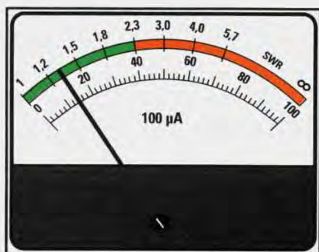
Fig.5 Poichè in questo rosmetro viene usato un tester posto sulla portata 100 µA fondo scala, in questo disegno indichiamo il valore di ROS al quale corrispondono questi µA.
