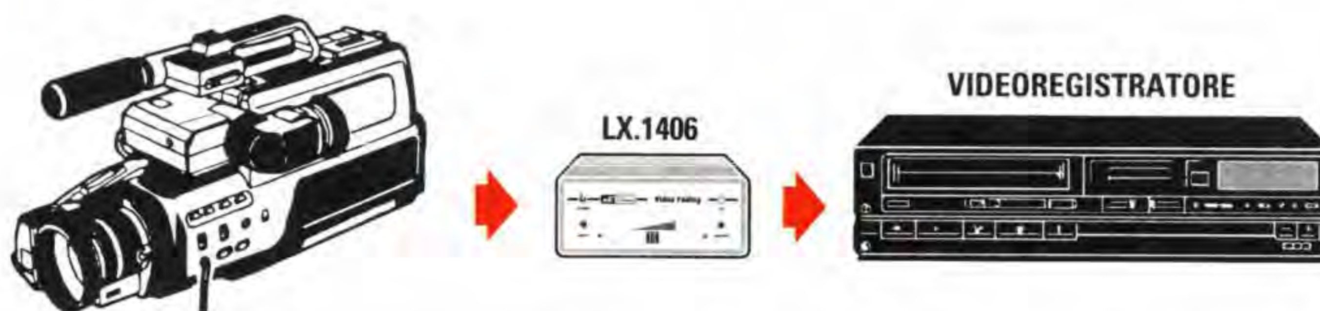
Fig.13 Le immagini possono essere prelevate anche dall'uscita video di una telecamera per elaborarle e trasferirle nel videoregistratore. Tramite la telecamera è possibile riprendere da un disegno dei titoli ed inserirli, con la dissolvenza, nel vostro montaggio.
