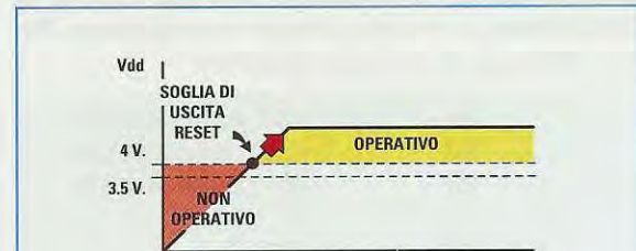
Fig.3 La funzione LVD mantiene un reset temporaneo nella fase di inizializzazione fino a quando la tensione di alimentazione non raggiunge un valore maggiore di 4 volt.
