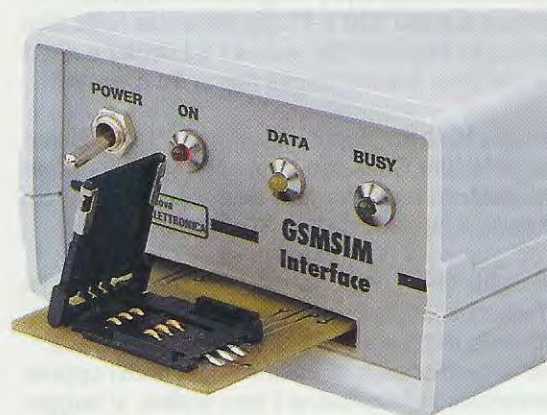
Fig.1 Tutti i numeri telefonici di un cellulare risultano memorizzati nella piccola scheda Sim Card. Inserendo questa scheda nel nostro circuito, potete vedere sul monitor del computer tutti i numeri memorizzati, inserirne dei nuovi, correggere gli errori, ecc. Assieme al kit vi verrà fornito un floppy contenente il software GSMSIM.
