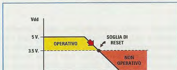
Fig.2 Utilizzando la funzione LVD, viene attivato in modo automatico un reset temporaneo se la tensione di alimentazione dovesse scendere sotto i 3,5 volt.
