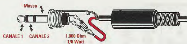
Fig.3 Poichè sull'ingresso del trasmettitore bisogna applicare un segnale Mono, ai due terminali interni è necessario collegare due resistenze da 1.000 ohm 1/8 di watt.
