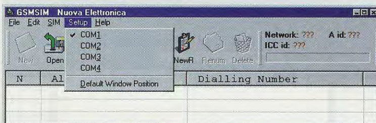
Fig.7 Se alla Com1 avete collegato il mouse, dopo aver cliccato su Setup selezionate la Com2 cliccando sulla seconda riga.
