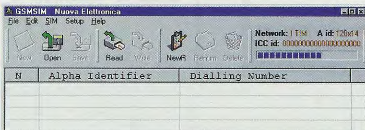
Fig.8 Dopo aver inserito la Sim Card nel suo connettore, cliccate sull'icona Read e in alto vedrete una barra a quadretti scorrere verso destra.
