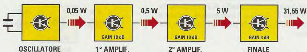
Fig.413 Utilizzando dei transistor con un guadagno maggiore, in uscita otterrete una potenza maggiore. Se il primo stadio, anzichè guadagnare 6 dB ne guadagna 10, dalla sua uscita preleverete 0,5 watt, se il secondo stadio guadagna nuovamente 10 dB, dalla sua uscita preleverete 5 watt e se l'ultimo stadio guadagna solo 8 dB, dalla sua uscita preleverete ben 31,55 watt (vedi Tabella N.3).
