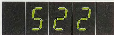
Fig.30 Per le frequenze minori di 1.000 KHz vedrete apparire sui display le sole tre cifre dei Kilohertz.
