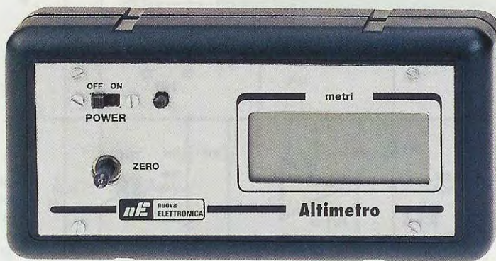
Fig.5 Ecco come si presenta il vostro altimetro dopo che l'avrete racchiuso nel suo mobile plastico. Il perno che fuoriesce in basso a sinistra è quello del potenziometro R5, che ci serve per la taratura sullo zero.
