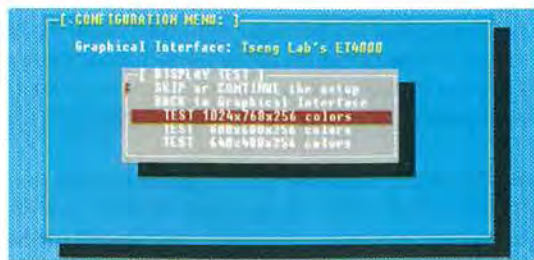
Fig.13. Andate sulla terza riga e pigiate Enter. Se la scheda è una Tseng, vedrete apparire il monoscopio di fig.17.
