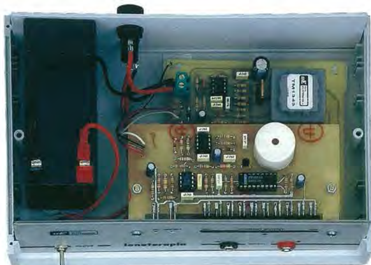
Fig.1 Foto di sinistra: il puntale va collegato alla boccia Negativa e la placca di gomma conduttrice alla boccia Positiva .
