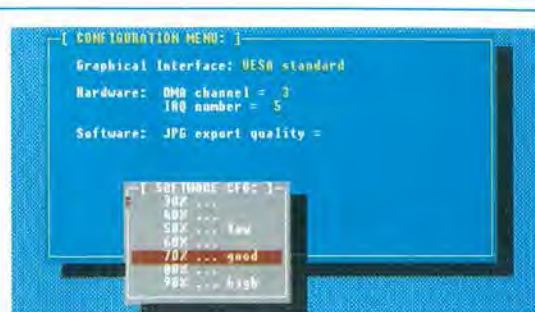
Fig.25 Per ottenere un compromesso tra qualità e memoria occupata, tutte le immagini vengono compresse di un 70%.
