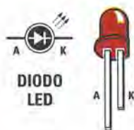
Fig.559 Nei diodi led, il terminale più lungo è l'Anodo e il più corto è il Catodo. Sulla destra abbiamo riportato le connessioni dell'integrato C/Mos 4011 viste da sopra e con la tacca di riferimento a U rivolta verso sinistra.
