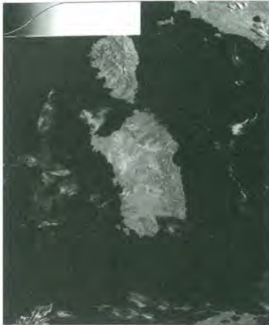
Fig.43 Dopo aver pigiato i tasti da F1 a F8 per trovare la combinazione che vi permette di avere una regolazione di contrasto e luminosità accettabile, potete ancora correggere questi valori manualmente tenendo pigiato uno dei due tasti Shift e premendo contemporaneamente uno dei tasti con le quattro frecce (leggere testo). La fascia che appare in alto scomparirà pigiando uno dei tasti freccia senza lo Shift.
