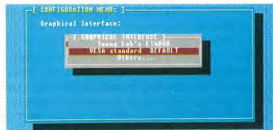
Fig.16. Se non appare nessun monoscopio, dovrete ripetere le operazioni appena descritte scegliendo la scheda VESA.
