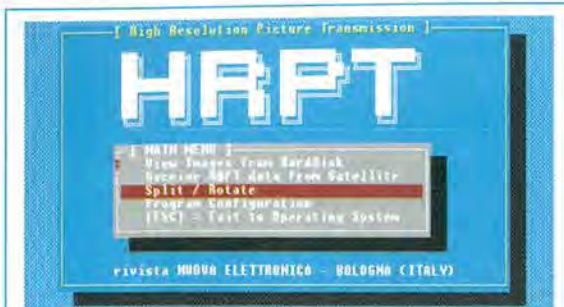
Fig.33 Per “splittare” le 5 lunghe fasce di fig.32 dovete portare la fascia rossa sulla scritta Split / Rotate e pigiare Enter.
