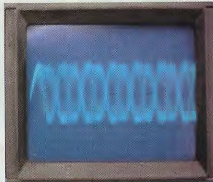
Fig.18 Appena il segnale HRPT del satellite verrà captato, sullo schermo appariranno tanti 0000 leggermente sfuocati. Agendo sulle 4 leve del box Controllo (vedi fig.26) dovrete cercare di non perdere il segnale e di renderlo più definito.
