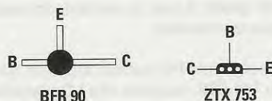
Fig.29 Connessioni del transistor BFR.90 (il Collettore è più lungo) e quelle del transistor ZTX.753 viste da sotto.
