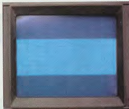
Fig.17 Chi ha un oscilloscopio può collegarlo alla presa "uscita oscilloscopio" (vedi fig.4) predisponendo la Sensibilità su 0,5 V per quadretto e la Base Tempi su 1 microsec. In assenza di segnali HRPT sullo schermo appare una fascia.
