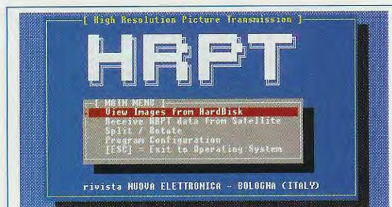
Fig.2 Se dalla fig.1 premete Enter, appare questa finestra che vi dà la possibilità di Vedere, Ricevere e Splittare le immagini .RAW. L'opzione riportata sulla quarta riga serve per Configurare il programma.
