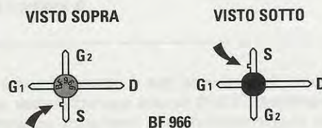
Fig.28 Connessioni viste da sopra e da sotto del transistor BF.966. Si noti la piccola "tacca" sul terminale Source.
