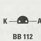
Fig.7 Le connessioni degli stabilizzatori di tensione, del fet, del transistor e del diodo varicap, sono viste tutte da sotto.
