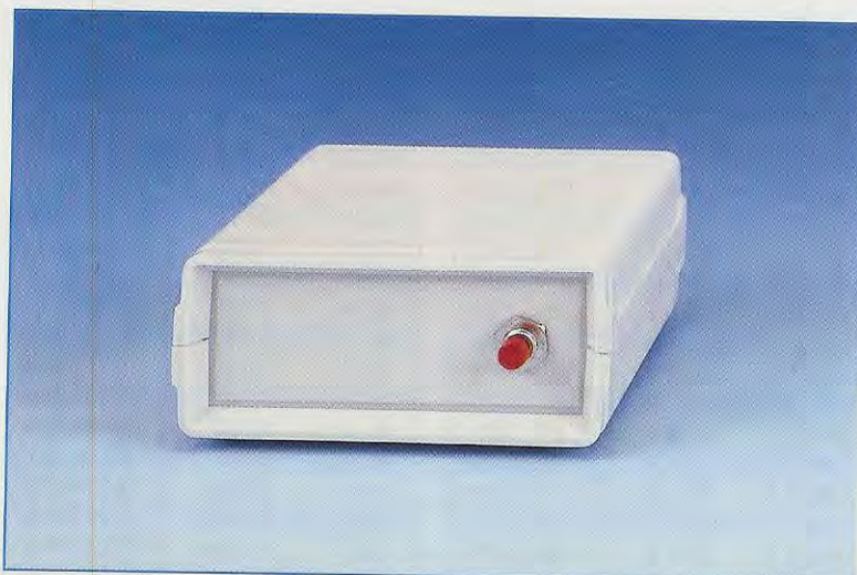
Fig.1 In questo Timer abbiamo un solo pulsante di Start che, premuto, fa eccitare un diodo Triac (vedi fig.3). All'uscita del Triac potete collegare una qualsiasi apparecchiatura che funzioni con una tensione di rete.
