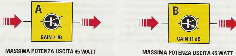
Fig.22 Se abbiamo due transistor, che nel nostro esempio abbiamo indicato A e B, che erogano entrambi una potenza di 45 Watt, il transistor più sensibile sarà quello che ha un maggiore guadagno. Quindi il transistor più sensibile sarà il B (visibile a destra) che ha un guadagno di 11 dB contro i 7 dB del transistor A (visibile a sinistra).
