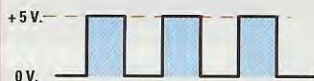
Fig.2 Le tensioni che passano istantaneamente da un valore di 0 volt ad un valore positivo di 5 volt sono segnali Digitali.
