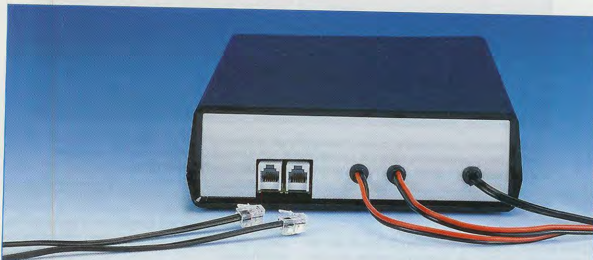
Fig.10 In uno dei due Plugs femmina presenti sul pannello posteriore inserite il Plug maschio che avrete sfilato dal corpo del vostro telefono e nell'altro Plug femmina inserite il Plug maschio presente nello spezzone di cavo inserito nel kit. L'altro Plug maschio presente in questo spezzone di cavetto deve essere inserito nel Plug femmina presente nel vostro apparecchio telefonico (vedi fig.3).
