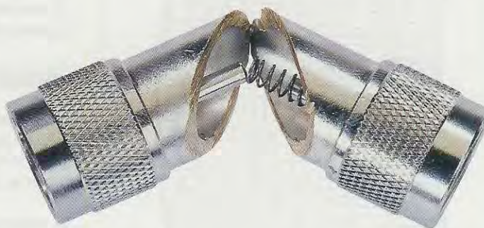
Fig.11 Non riuscendo a comprendere perché molti connettori economici introducevano una attenuazione di circa 4 dB, li abbiamo sezionati e così abbiamo scoperto la "molla" di contatto, che, per i segnali SHF, si comporta come una impedenza JAF.
