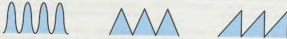
Fig.1 Sono definiti segnali "analogici" tutti i segnali che variano nel tempo da un valore minimo ad uno massimo in modo graduale, come avviene per le onde di forma sinusoidale, oppure triangolari o a dente di sega.
