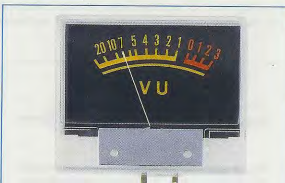
Fig.28 Se la lancetta dovesse raggiungere solo i 7 dB, otterremo in uscita una potenza 5 volte inferiore al valore max.
