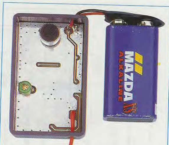
Fig.5 Dopo aver inserito il trasmettitore nel suo mobile, dovete fare un foro sul coperchio in corrispondenza del microfono. Molti investigatori non applicano questo coperchio, perché il microfono riesce a captare con più facilità i segnali deboli.
