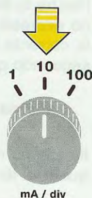
Fig.22 Se la manopola della Corrente di Collettore risulta posizionata sulla seconda portata di 10 mA/div e quella dell'asse verticale Y rimane fissa sulla portata di 0,1 volt, ogni quadretto verticale corrisponderà ad una corrente di 10-20-30-40-50-60-70-80 mA.
