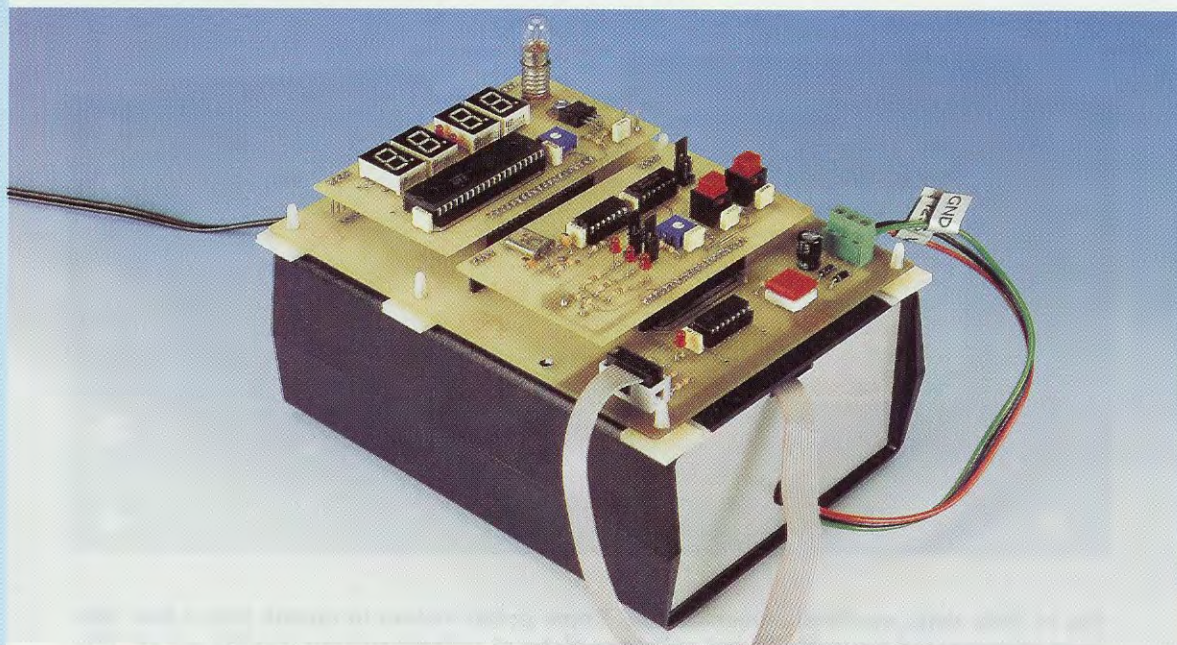
Fig.16 Chiusi i due semicoperchi del mobile plastico, sopra ad esso potete fissare, utilizzando sempre 4 distanziatori plastici con base autoadesiva, il circuito stampato del Bus siglato LX.1547. Sul pannello frontale di questo mobile dovete aprire un'asola per far passare la piattina di collegamento e un foro per i 3 fili di alimentazione.
