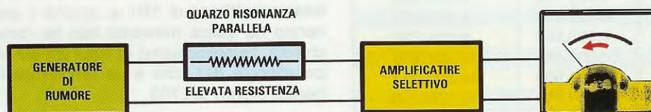
Fig.7 Sapendo che un quarzo quando oscilla sulla sua frequenza di Risonanza Parallelo ha una ELEVATA RESISTENZA, se su un suo piedino d'ingresso applicate un Generatore di Rumore che riesce a raggiungere i 60-70 MHz e sul piedino d'uscita applicate un Amplificatore Selettivo, quando lo sintonizzerete sulla esatta frequenza di Risonanza Parallelo vedrete la lancetta del voltmetro deviare verso sinistra.
