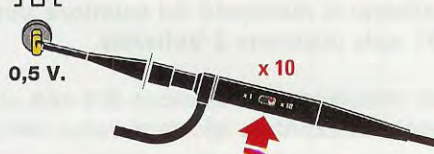
Fig.13 Se il deviatore presente nel puntale risulta posto su x10 e volete vedere nuovamente un segnale con la medesima ampiezza di quello di fig.12, dovete spostare il selettore CH1 dalla portata "0,1 volt x divisione" (vedi fig.12) alla portata "10 millivolt x divisione" in modo da aumentare la sensibilità.
