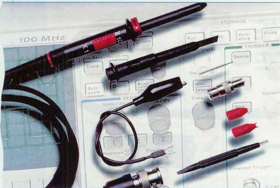
Fig.1 Acquistando un oscilloscopio vi verrà sempre fornito un puntale che può avere una attenuazione x1 o x10 oppure un puntale che si può predisporre, tramite un piccolo deviatore, per un'attenuazione x1 - x10 (vedi fig.3).
