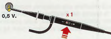
Fig.12 Ruotando la manopola Time/div. sulla posizione "0,2 millisecondi" e la manopola del Volts/div. sulla portata "0,1 volt x divisione", sullo schermo appariranno 2 onde quadre con un'ampiezza di 5 quadretti solo se dal terminale CAL esce un segnale di 0,5 volt e il deviatore del puntale risulta posto su x1.
