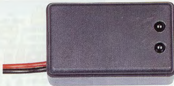
Fig.11 Sul coperchio del contenitore plastico di fig.10 dovrete praticare due fori per far uscire la testa dei diodi CQX.89.
