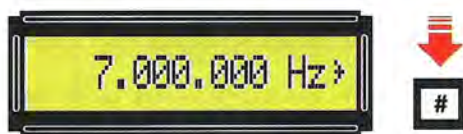
Fig.50 Digitate la frequenza che volete ottenere poi confermatela con il tasto #.
