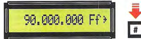
Fig.42 Ripremete il tasto # e quando apparirà "0 Ff" (vedi fig.36) digitate il numero 90.000.000 e poi il tasto di conferma #.
