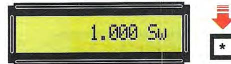
Fig.44 Premendo il tasto * potrete scegliere la "velocità di scansione", che in questo secondo esempio può essere di 1.000 Sw.
