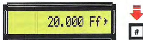
Fig.37 Digitate il numero 20.000, poi premete il tasto di conferma # e sul display vedrete apparire 20.000 Ff >.
