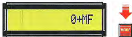
Fig.47 Premete "1 sola" volta il tasto Mode e sul display apparirà 0+MF.
