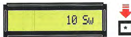
Fig.39 Premendo il tasto * potrete scegliere la "velocità di scansione", che può essere di 1-10-100-1.000 Sw, ecc.
