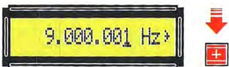
Fig.25 Premendo il tasto + la frequenza salirà di 1 Hertz. Utilizzando i tasti +/- per il cambio frequenza non sarà più necessario premere il tasto # di conferma.
