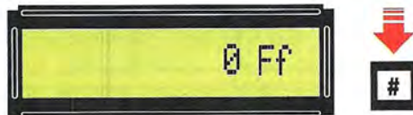
Fig.36 Ripremete il tasto # e sul display apparirà "0 Ff" che indicherà il valore della Frequenza Finale del vostro Sweep.
