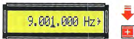
Fig.28 Premendo il tasto + la frequenza salirà di 1.000 Hz per volta. Arrivati alla frequenza di 9.009.000 Hz, questa continuerà a salire sempre di 1.000 Hz.
