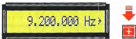
Fig.32 Premendo il tasto + la frequenza salirà sempre con salti da 100.000 Hz, cioè di 100 KHz. Premendo il tasto - la frequenza scenderà sempre di 100 KHz.
