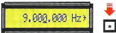
Fig.27 Se desiderate variare la frequenza di 9.000.000 Hz > di 1.000 Hz in +/-, dovrete premere il tasto * in modo da sottolineare il quarto 0 a partire da destra.
