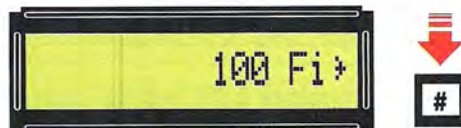
Fig.35 Iniziate digitando il numero 100, poi premete il tasto di conferma # e sul display vedrete apparire 100 Fi >.
