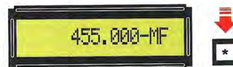
Fig.57 Premete "1 volta" il tasto * e sul display vi apparirà la dicitura -MF.
