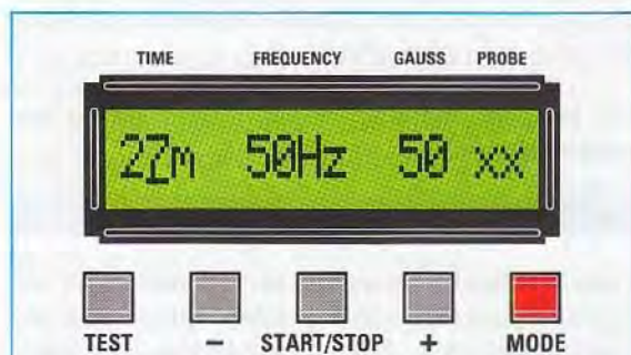
Fig.25 Per impostare il tempo della seduta premete il pulsante Mode fino a sottolineare il valore numerico relativo alla scritta Time, quindi premete i pulsanti + e -.
