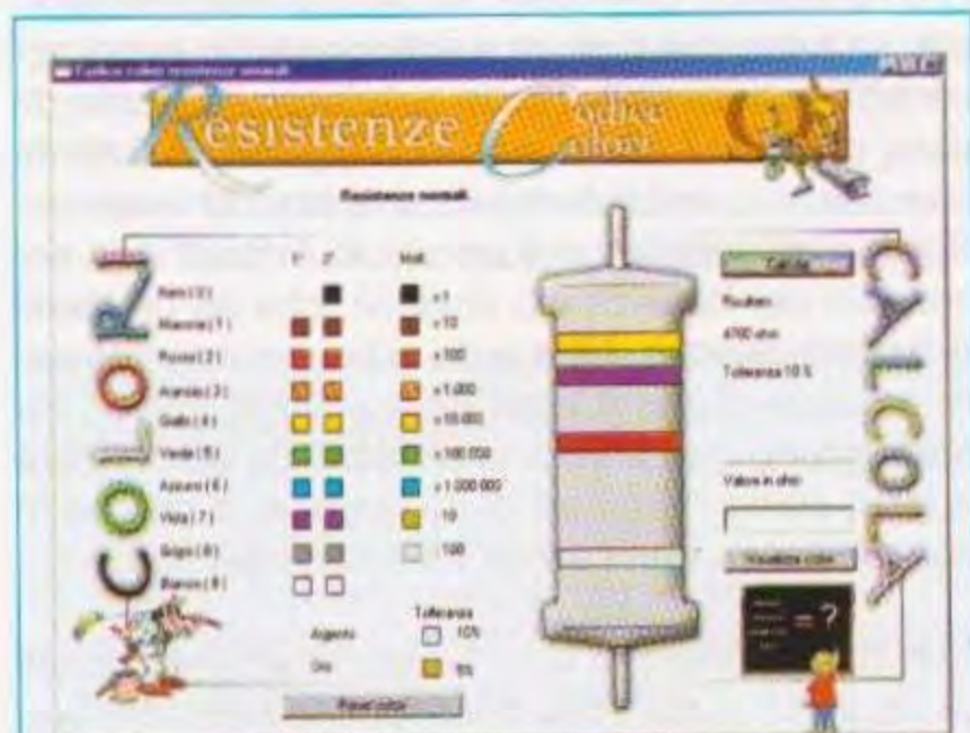
Fig.1 Nella sezione Codice colori delle resistenze si può sia selezionare i colori per calcolare il valore della resistenza sia digitare un valore per visualizzarne i colori.
