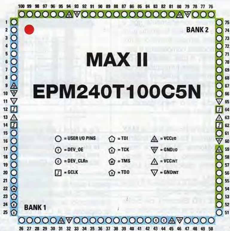
Fig.2 Piedinatura del MAX II siglato EPM240T100C5N prodotto dalla Altera. E' un chip a logica programmabile con ben 100 piedini di cui 80 di I/O. I piedini dedicati alla programmazione sono 4: la linea di controllo TMS è gestita tramite il pin 22, la linea di clock TCK è gestita tramite il pin 24, mentre le linee TDI e TDO (vedi pin 23 e 25) sono riservate alla programmazione del chip e relativo controllo secondo lo standard JTAG.
