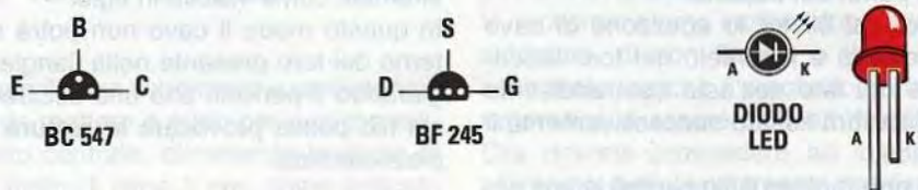
Fig.3 Connessioni del transistor BC.547 e del fet BF.245 viste dal basso: da notare la disposizione dei terminali E-B-C nel primo caso e dei terminali D-S-G nel secondo caso. A destra connessioni del diodo led con il terminale Anodo (più lungo) disposto a sinistra.
