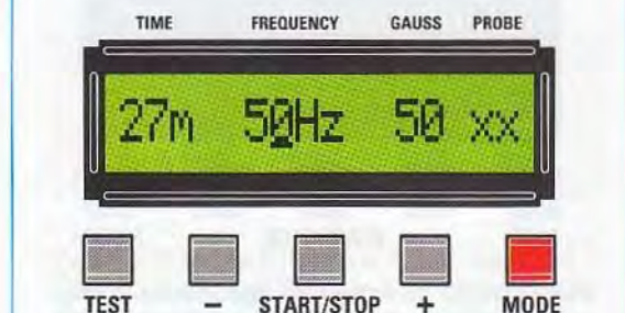
Fig.26 Per impostare la frequenza premete il pulsante Mode fino a sottolineare il valore numerico relativo alla scritta Frequency, quindi premete i pulsanti + e -.
