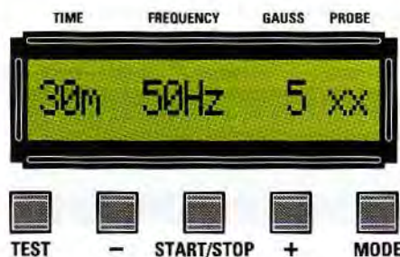
Fig.24 Tutte le volte che accendete la magnetoterapia a 100 gauss, sul display LCD appaiono i valori predefiniti che abbiamo raffigurato in questo disegno.
