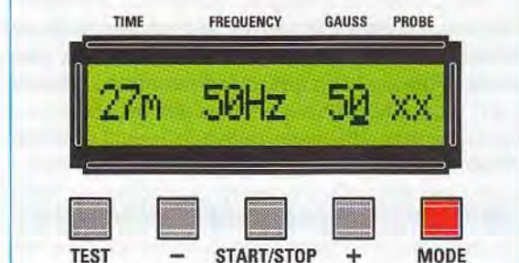
Fig.27 Per impostare la potenza premete il pulsante Mode fino a sottolineare il valore numerico relativo alla scritta Gauss, quindi premete i pulsanti + e -.
