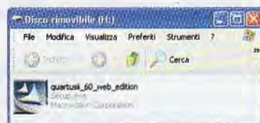
Fig.17 Cliccando due volte sull'icona della periferica in cui avete inserito il CDR1685 (vedi fig.16), compare questa finestra. Per lanciare l'installazione del software Quartus II cliccate due volte sul nome del programma.
