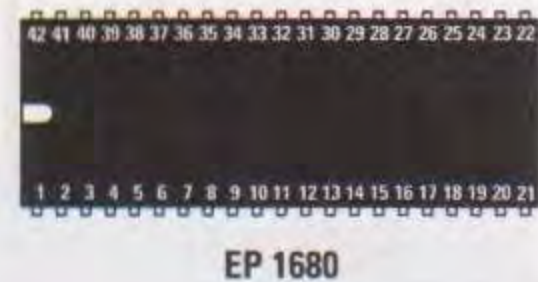
Fig.7 Connessioni viste da sopra del microprocessore ST72C334 che vi viene fornito già programmato con la sigla EP1680 per svolgere tutte le funzioni necessarie al funzionamento della magnetoterapia.
