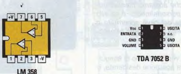
Fig.2 A sinistra sono raffigurate le connessioni dell'integrato LM358 viste da sopra e con la tacca di riferimento rivolta verso sinistra, a destra, le connessioni dell'integrato TDA7052B viste sempre da sopra ma con la tacca di riferimento rivolta verso l'alto.
