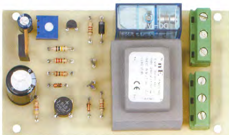
Fig.3 Disegno dello schema di montaggio dell'automatismo contro i blackout. I diodi led vanno collegati solamente dopo averli montati sulla scatola in cui inserirete il circuito.
