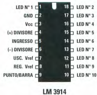
Fig.5 Le connessioni dell'integrato IC3 siglato LM.3914 e quelle dell'integrato IC1 siglato TL081 viste da sopra e con la tacca di riferimento a U posta in alto. L'integrato IC2 siglato L.7805 o uA.7805 è visto frontalmente. Il terminale di sinistra E è l'ingresso, quello centrale M è la massa e quello di destra U è l'uscita. Il terminale più lungo dei diodi led è l'Anodo che va collegato alla tensione dei 12 Volt, mentre il terminale più corto è il Catodo (K) che va collegato alle uscite di IC3.
