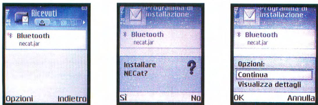
Fig.5 In sequenza potete vedere le immagini che appaiono sul vostro cellulare per portare a termine l'installazione del programma NECat. Per queste immagini ci siamo avvalsi di un Nokia 6630. Se avete un altro telefonino le immagini potrebbero apparire diverse, ma nella sostanza il procedimento non cambia: lanciate l'esecuzione di necat.jar, quindi rispondete affermativamente quando vi viene chiesto di installare il programma.
