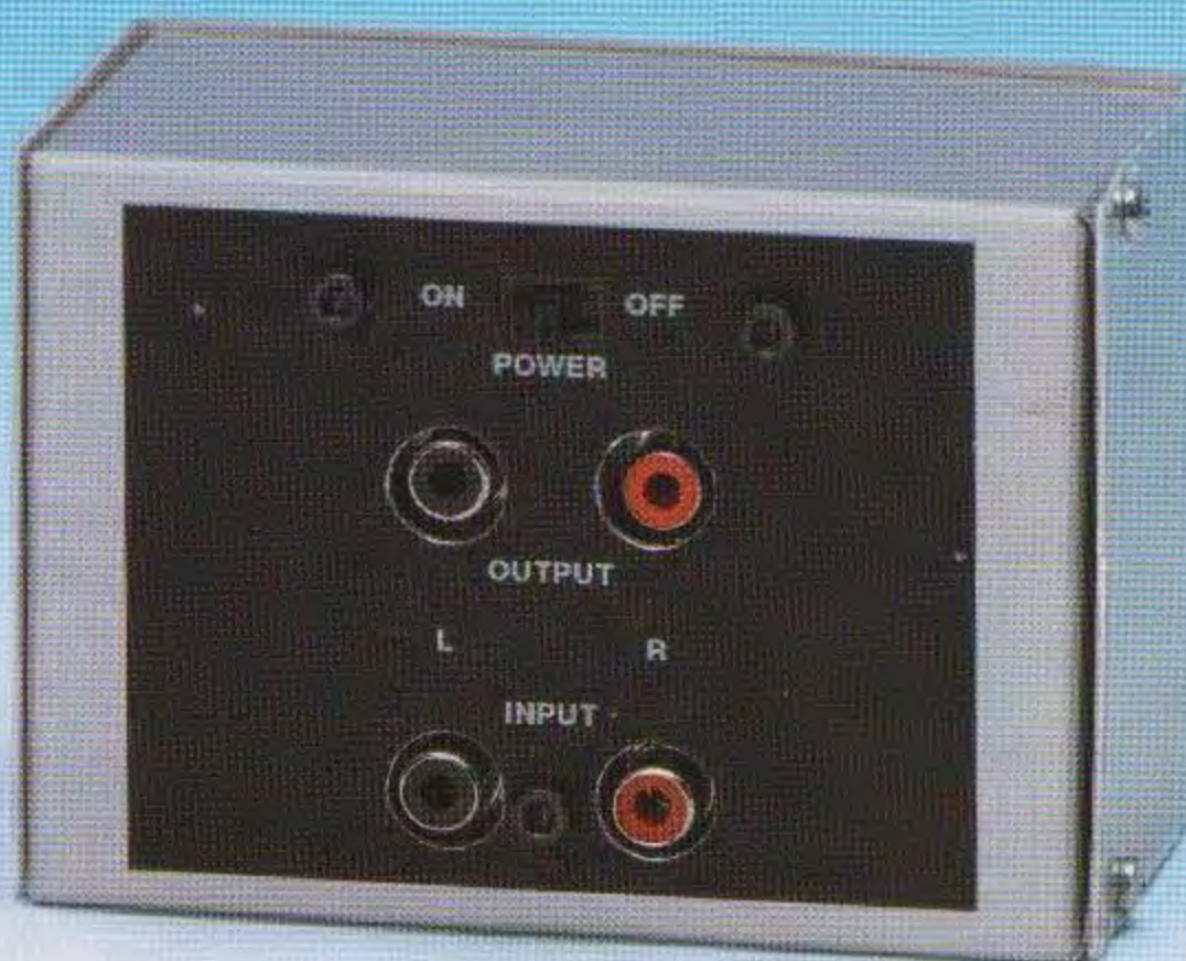
Fig.17 Foto del preamplificatore RIAA stereo racchiuso dentro il mobile metallico che vi forniamo già forato e con una mascherina adesiva di colore nero.
