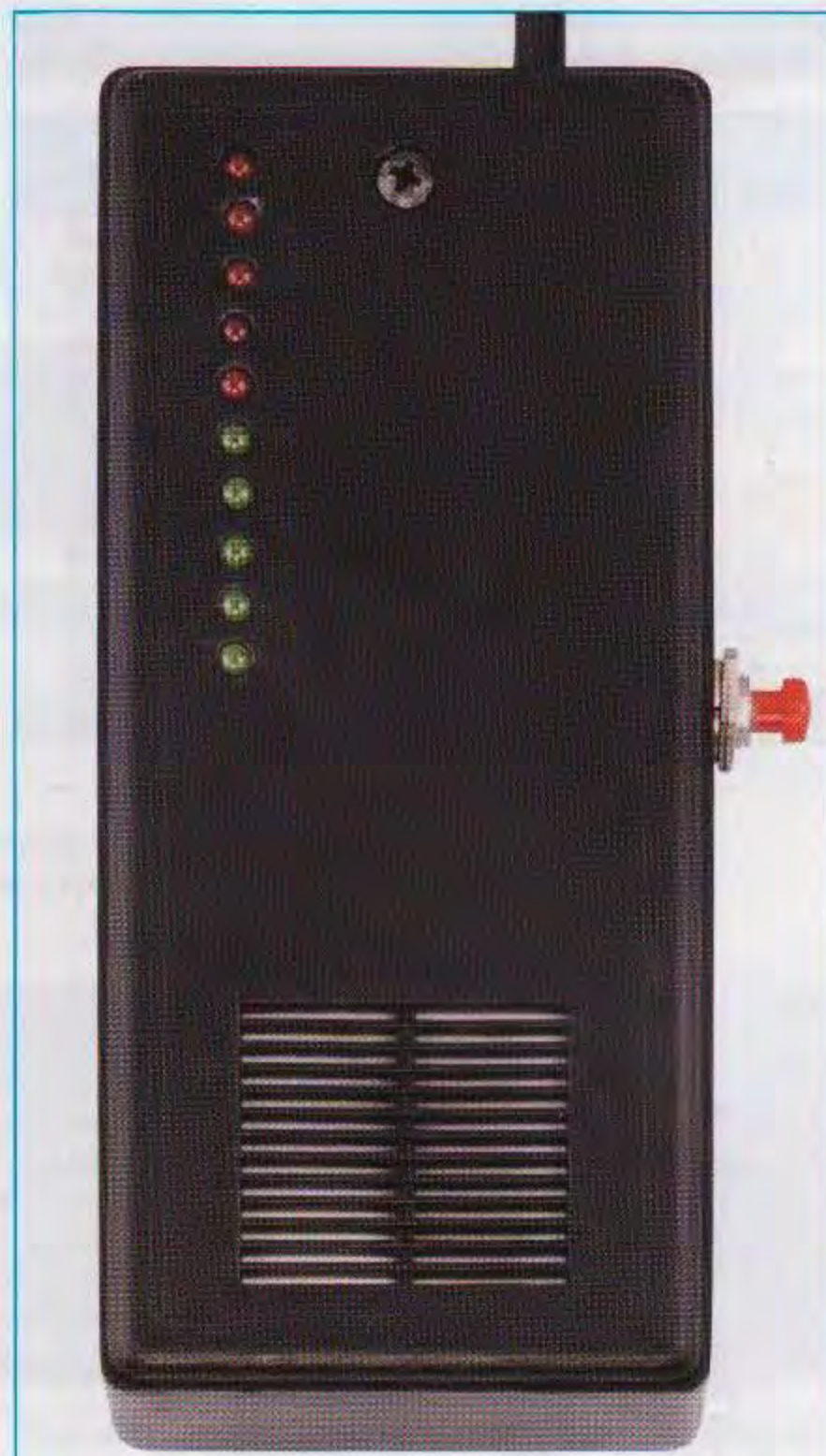
Fig.7 Sul coperchio del mobile plastico c'è un'apertura a griglia. Soffiandoci attraverso, questa permette al fiato di raggiungere la sonda dell'Etilometro. Soffiate energicamente per far uscire l'aria che risulta presente all'interno del mobile.
