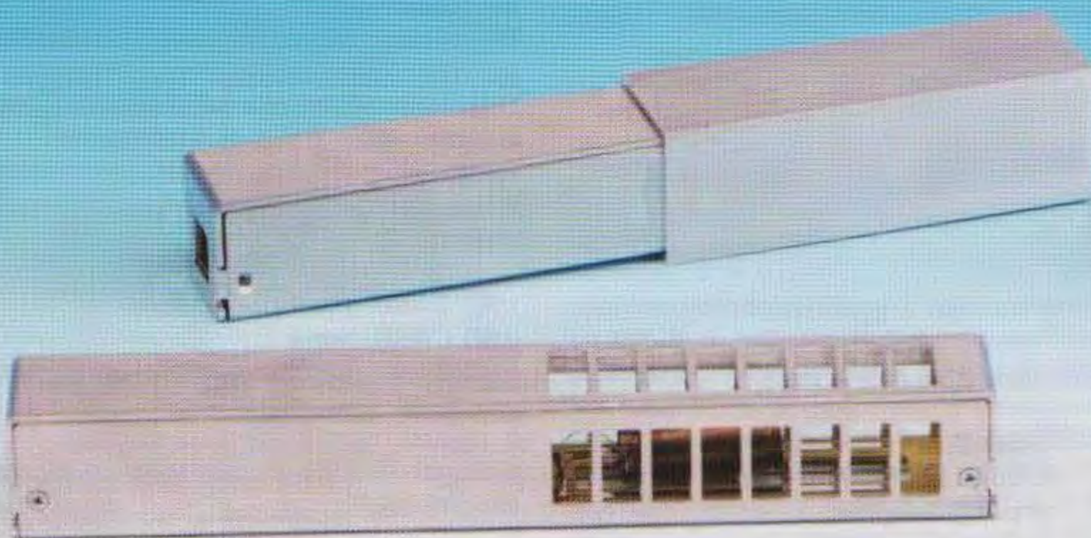
Fig.42 Nella fotografia sono rappresentati i due diversi tipi di misurazione che è possibile eseguire con il contatore Geiger. In basso, in assenza dello schermo metallico, il sensore capta la somma di tutte le radiazioni presenti. In alto, dopo avere inserito lo schermo metallico, le radiazioni alfa e beta vengono arrestate. In questo caso il sensore misura unicamente la radiazione gamma. Sottraendo alla lettura effettuata senza lo schermo metallico la lettura eseguita con lo schermo è possibile ricavare per differenza il valore della radiazione beta.
