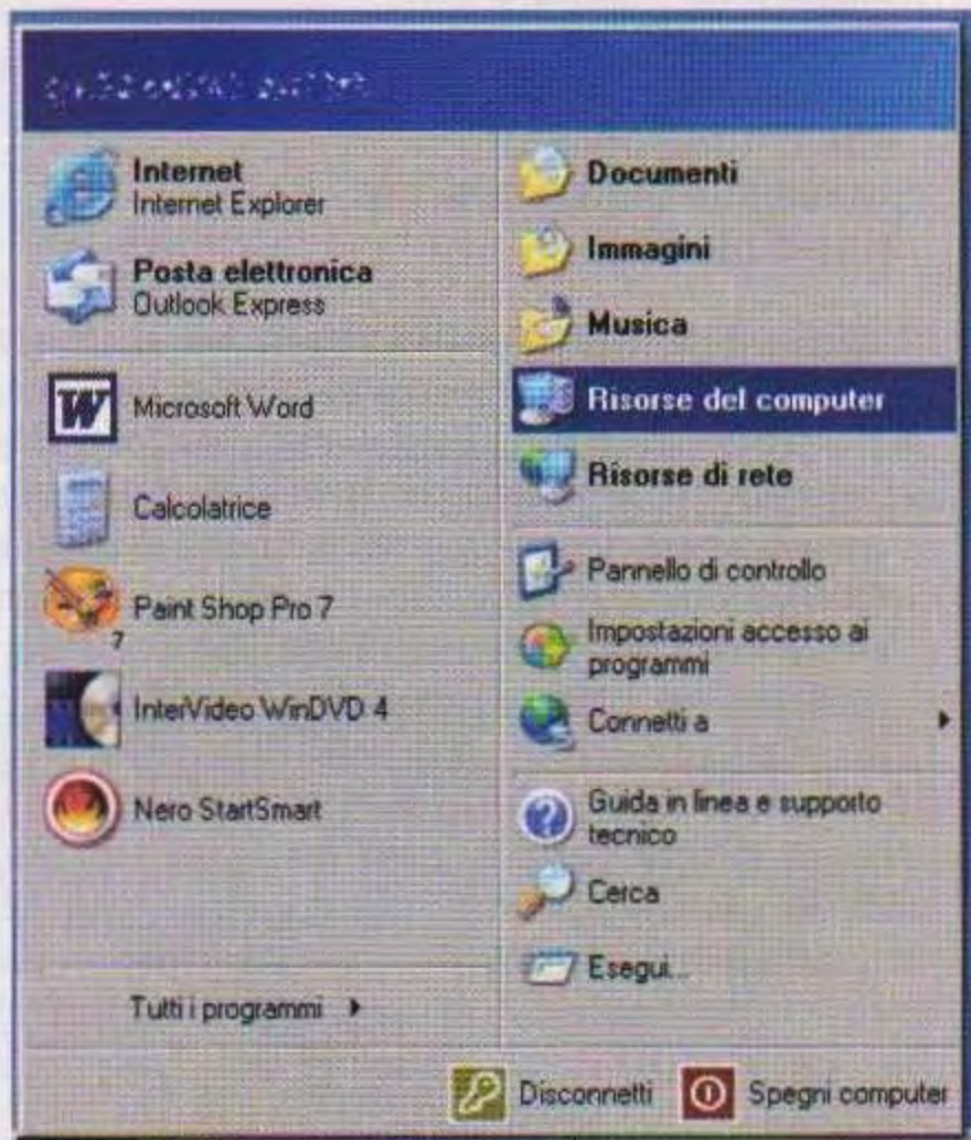
Fig.30 Per formattare l'SD card, collegate alla porta USB del vostro pc il Card reader, come visibile in fig.28. Quindi dal menu principale di Windows XP premete il tasto Start e sulla finestra che compare successivamente selezionate l'opzione Risorse del computer.
