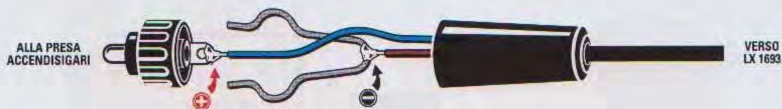
Fig.8 I fili Blu-Marrone saldati sui capicorda posti vicino alla scritta 12 volt (vedi fig.4) vanno collegati allo spinotto dell'accendisigaro inserito nel kit. Per la precisione, dopo aver sfilato l'involucro dello spinotto, il filo Marrone va saldato alla graffetta metallica, mentre il filo Blu va saldato al terminale centrale dello spinotto.
