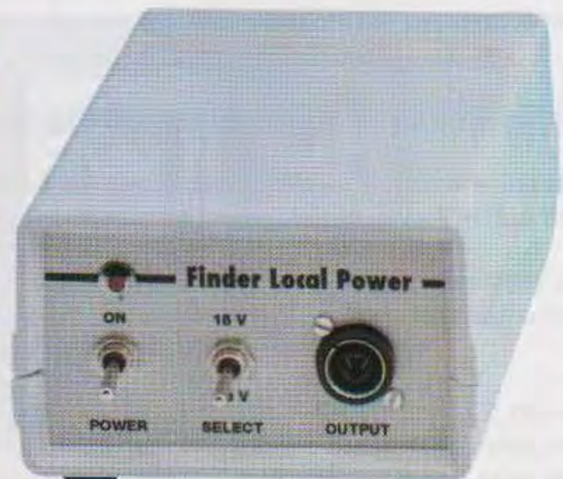
Fig.11 Come si presenta la serigrafia pre- sente sul pannello frontale di questo ali- mentatore per il Satellite FINDER.
