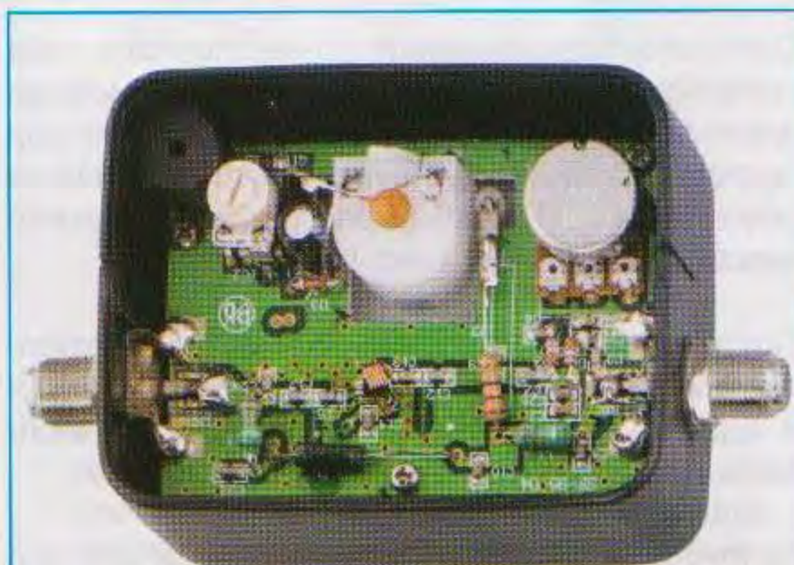
Fig.2 All'interno del Satellite Finder è inserito un amplificatore che amplifica tutti i segnali TV di circa 11 dB. Sul coperchio di questo amplificatore sono riportate vicino al connettore a F di destra la scritta "TO REC", mentre vicino al connettore a F di sinistra la scritta "TO LNB", da collegare al convertitore LNB (vedi fig.3).
