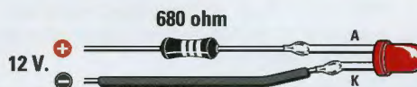
Fig.5 Per alimentare un diodo led Rosso con una tensione di 12 Volt, è necessaria una resistenza da 680 ohm.
