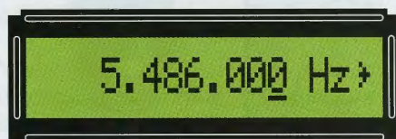
Fig.6 Per variare la frequenza impostata dovete premere il tasto * e noterete così che il primo 0 di destra verrà sottolineato per segnalare che, premendo i tasti + o -, si modificherà questo numero.
