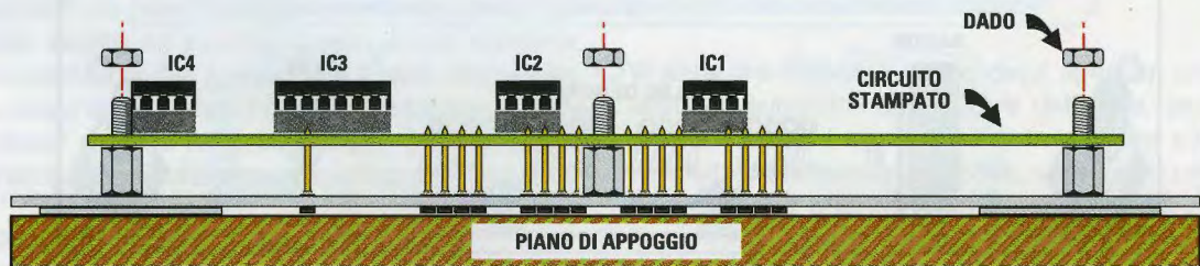
Fig.23 Completato il fissaggio della scheda base del Minilab LX.3001 sulla mascherina, potete togliere i dadi di fissaggio e separare il circuito stampato dalla mascherina girandolo dal lato opposto per completare il montaggio dei componenti.
