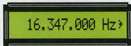
Fig.26 Dopo aver digitato il numero richiesto, per prelevare dall'uscita del Generatore DDS questa frequenza premete il tasto # in modo che appaia sulla destra di Hz il simbolo > di conferma.
