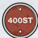
Fig.1 Sul retro del corpo della capsula TRASMITTENTE è presente la sigla 400ST . Le altre scritte che troverete sotto a tale sigla non sono significative.
