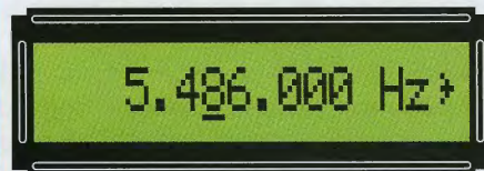
Fig.7 Poichè inizialmente conviene variare la frequenza delle decine di migliaia di Hz, premete il tasto * in modo da sottolineare il numero 8. Per sapere come spostare la sottolineatura, leggete il testo.
