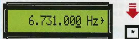
Fig.18 Per variare la frequenza imposta dovete premere sul tasto * e noterete che il primo 0 di destra verrà sottolineato per segnalare che, premendo i tasti + o -, si modificherà questo numero.
