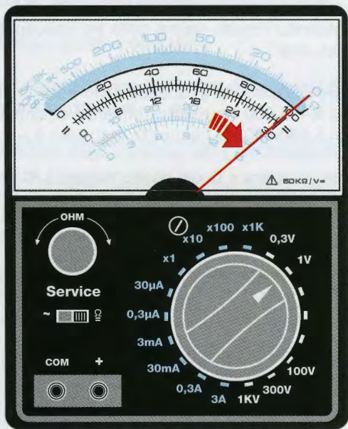
Fig.9 Ottenuta l'esatta frequenza di sintonia, commutate il tester sulla portata 1 Volt CC, poi ruotate il potenziometro R5 (vedi fig.1) in modo da portare la lancetta sul fondo scala indicato 100.
