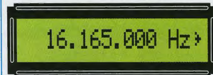
Fig.29 Per sintonizzarvi con una maggiore precisione sulla frequenza di sintonia, vi conviene variare le migliaia di Hz, quindi dopo aver sottolineato il numero 7 premete il tasto - fino a leggere 16.165.000 Hz.
