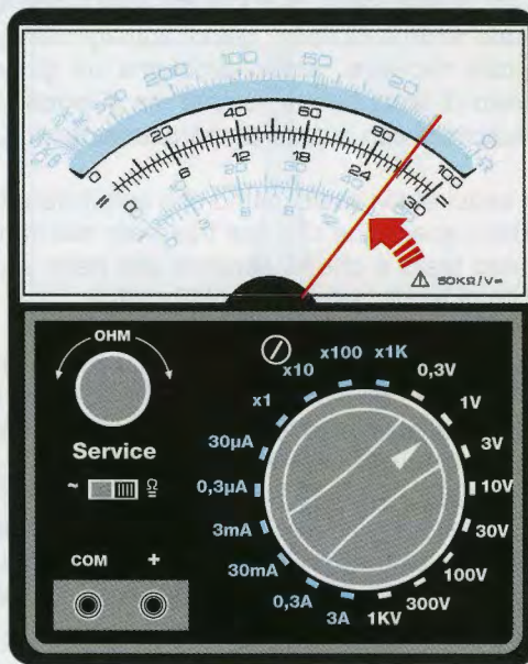
Fig.10 Per conoscere il valore delle frequenze F1-F2 a - 3 dB dovete premere i tasti + e - del Generatore DDS fino a portare la lancetta del tester sulla posizione 90 che corrisponde a 0,9 Volt.
