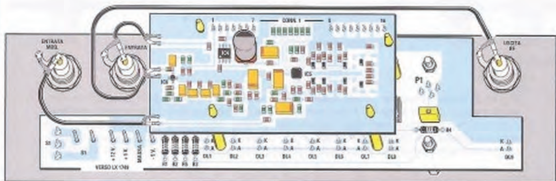
Fig.19 Sul circuito stampato in SMD siglato KM.1750K dovrete saldare sulle piste visibili in disegno, tre spezzoni di cavetto coassiale che poi collegherete ai BNC posti sul pannello indicati Entrata Mod. - Entrata RF e Usclta RF (vedi anche la fig.11).
