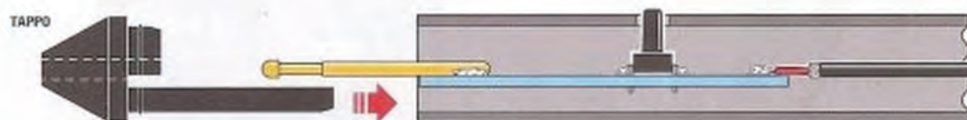
Fig.7 Prelevate il tappo e innestatelo nel tubo in modo che la guida in plastica si venga a trovare al di sotto dello stampato come indicato dalla freccia.
