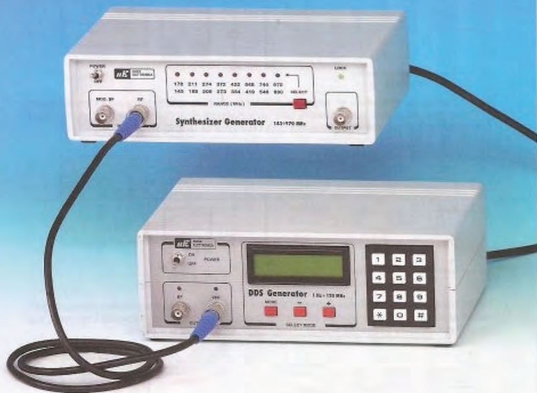
Fig.3 L'uscita VHF del Generatore DDS, che vi abbiamo presentato nella rivista N.226, verrà collegata tramite un cavetto coassiale, al BNC di ingresso del nostro Sintetizzatore. Premendo il tasto Select si accenderà sul pannello frontale il diodo led relativo alla sua gamma di lavoro. Nell'ingresso di questo Sintetizzatore potrete inserire anche il segnale prelevato da un qualsiasi Generatore o VFO purchè generino una frequenza compresa tra 14,3 MHz e 97,0 MHz (vedi Tabella N.1).
