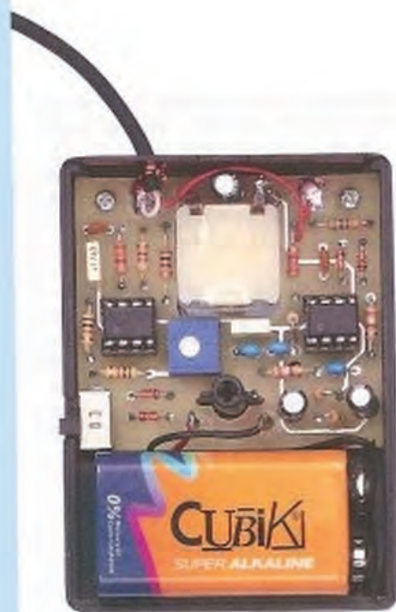
Fig.6 La fotografia riprodotta a sinistra mostra il piccolo circuito stampato dello skin detector alloggiato all'interno del contenitore. Al centro è visibile il lato posteriore del microamperometro e subito al di sotto il trimmer utilizzato per la taratura. A destra, vista interna del probe di misura.
