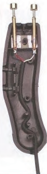
Fig.6 La fotografia riprodotta a sinistra mostra il piccolo circuito stampato dello skin detector alloggiato all'interno del contenitore. Al centro è visibile il lato posteriore del microamperometro e subito al di sotto il trimmer utilizzato per la taratura. A destra, vista interna del probe di misura.
