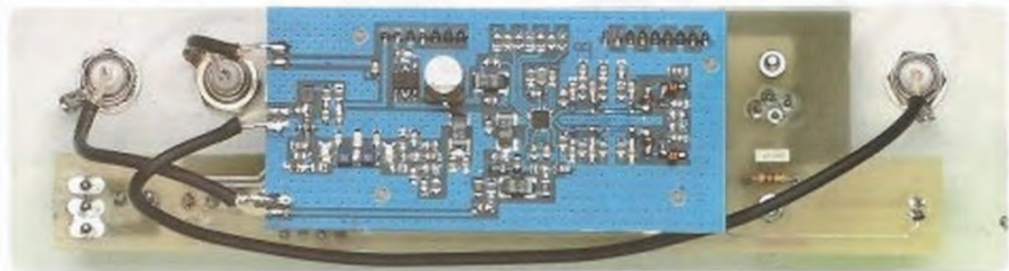
Fig.20 Foto del pannello frontale con sopra già fissati i due richiesti circuiti stampati. Quando collegherete i cavetti coassiali al circuito SMD, ricordatevi che la calza di schermo di ogni cavetto va saldata sulla pista di Massa.
