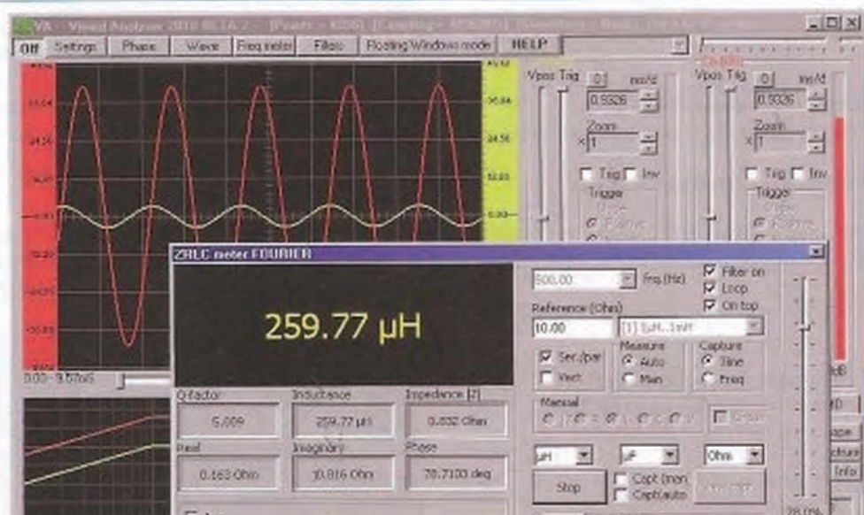
Fig.1 L'impedenziometro consente non solo di misurare con precisione il valore di qualsiasi condensatore o induttanza, ma anche di ricavare il loro Q, cioè il fattore di merito, che esprime in una certa misura la "bontà" del componente. Eviterete così di utilizzare un componente in modo inappropriato.
