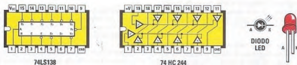
Fig.15 Le connessioni degli integrati 74LS.138 e 74HC244 viste da sopra e con la tacca di riferimento a U rivolta a sinistra. Nei diodi led il terminale Anodo è più lungo del K.
