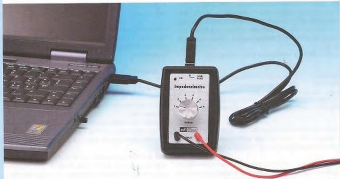
Fig.9 Nella fotografia è visibile il commutatore S1 che permette di selezionare le 5 diverse portate dello strumento. Per evitare errori di misura occorre verificare che la posizione del commutatore coincida sempre con il numero riportato alla voce corrispondente del software operativo.
