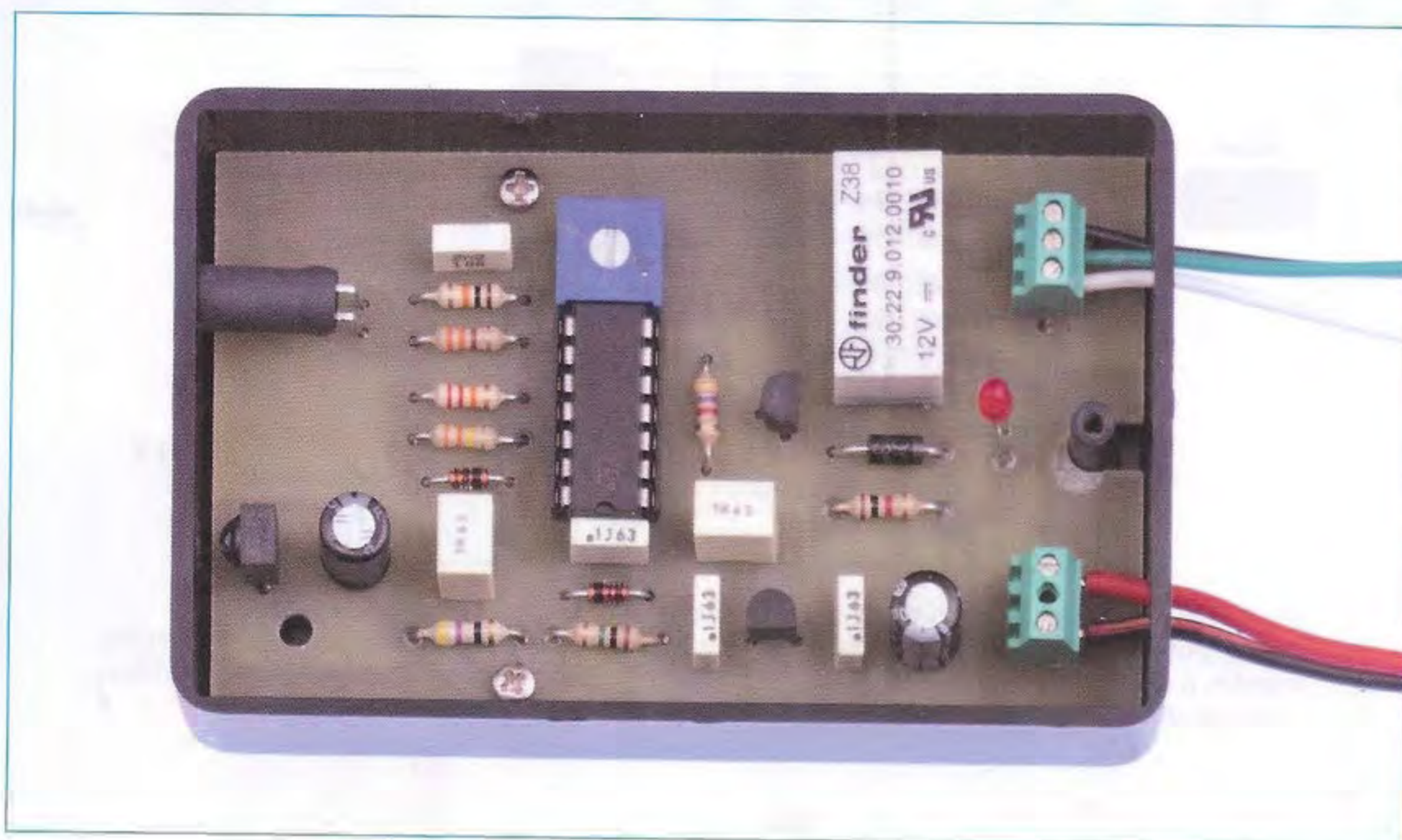
Fig.8 In questa foto potete vedere il circuito stampato montato e inserito all'interno del mobiletto plastico che vi forniamo con il kit.
