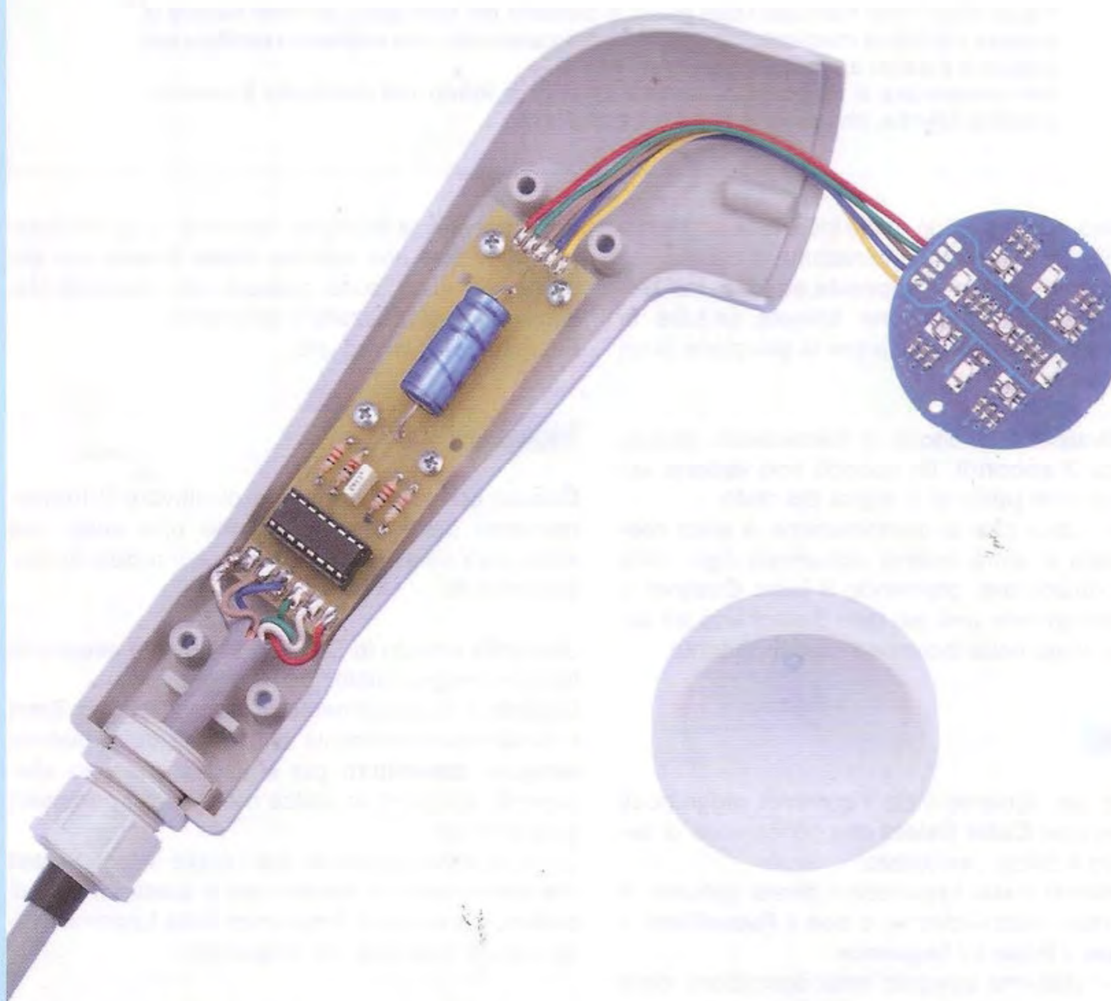
Fig.23 Ecco come si presenta il manipolo una volta inserite al suo interno la scheda LX.1761 e la scheda SMD KM1761K che alloggia i diodi led.
