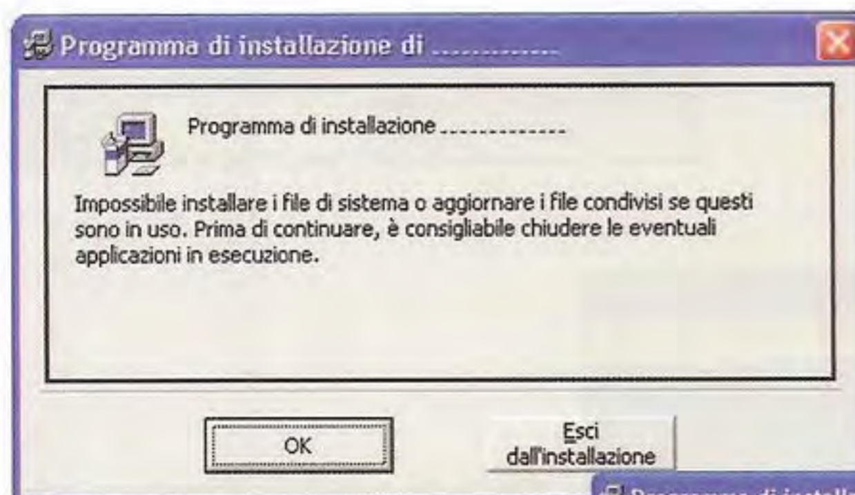
Fig.14 Per installare il programma dovete entrare nella cartella "pacchetti" del CDrom e poi nella cartella relativa all'applicazione, cliccando poi su "Setup.exe". Cliccate sull'icona del pc per avviare l'installazione.
