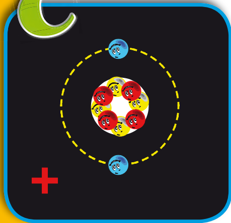
Fig.3 Se in un atomo si tolgono degli Elettroni questo assume una carica elettrica Positiva.
