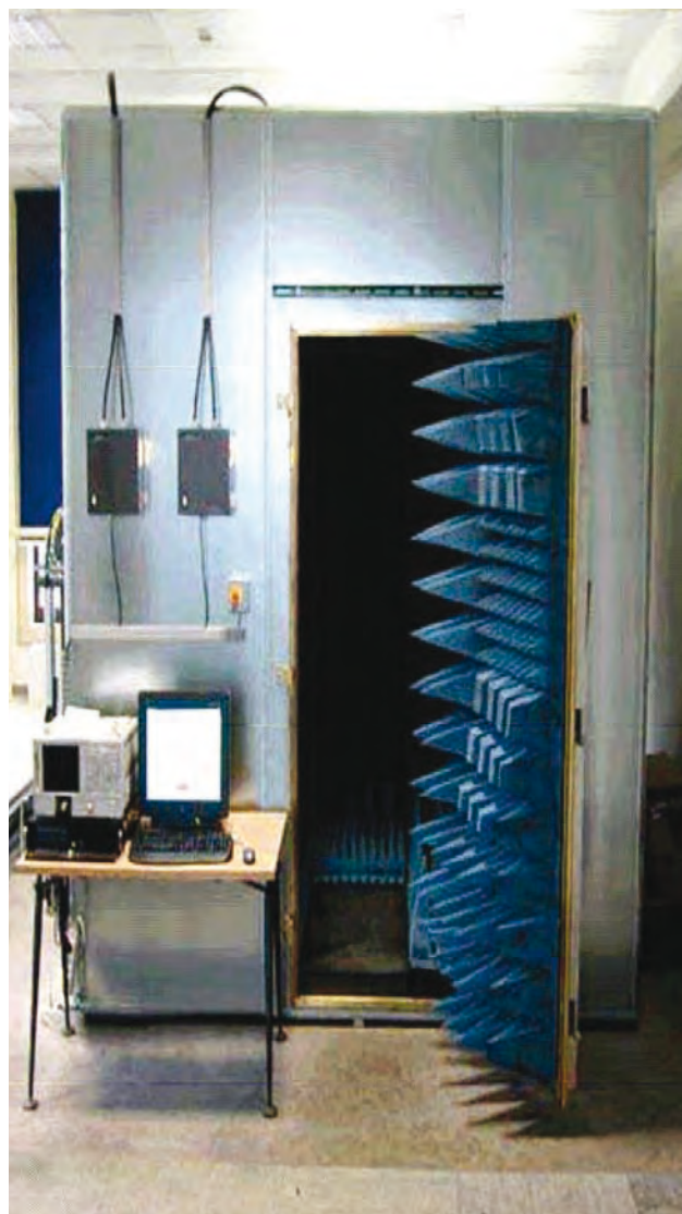
Fig.3 - Vista anteriore camera schermata e apparecchiature di misura.
