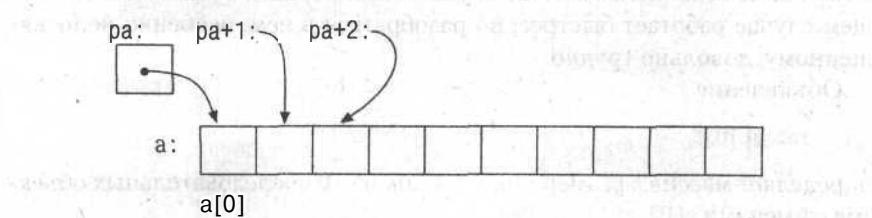
Сделанные замечания верны безотносительно к типу и размеру элементов массива *a*. Смысл слов "добавить 1 к указателю", как и смысл любой арифметики с указателями, состоит в том, чтобы *ra+1* указывал на следующий объект, а *ra+i* - на *i*-й после *ra*.
